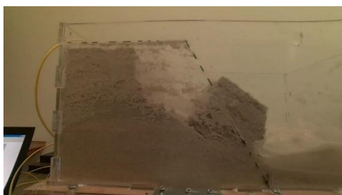
Εικόνα 87 Αστοχία Πρανούς, Figure 87 Slope Failure
