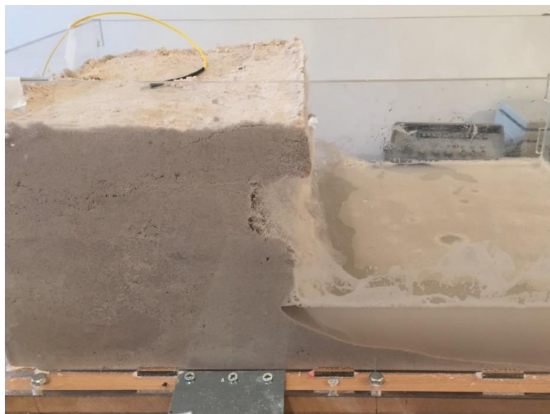
Εικόνα 301 Αστοχία Πειραματικού Μοντέλου λόγω Υποσκαφής του κατώτερου στρώματος και Δημιουργία Προβόλου στο ανώτερο
