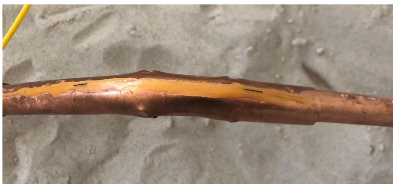
Εικόνα 259 Αισθητήρας Οπτικών Ινών στον Αγωγό Χαλκού,
