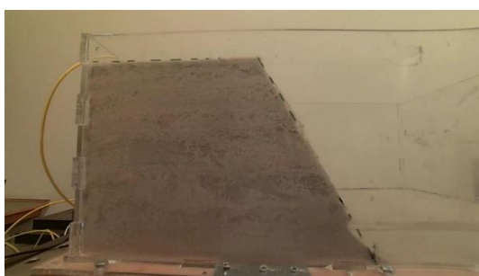
Εικόνα 83 Αρχική κατάσταση πρανούς προ Φόρτισης Figure 83 Initial Slope Condition before Load
