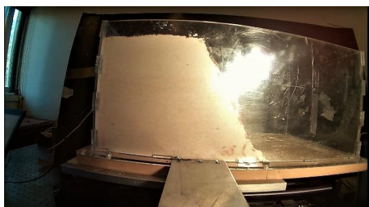
Εικόνα 101 Αρχική κατάσταση πρανούς προ Φόρτισης Figure 101 Initial Slope Condition before Loading
