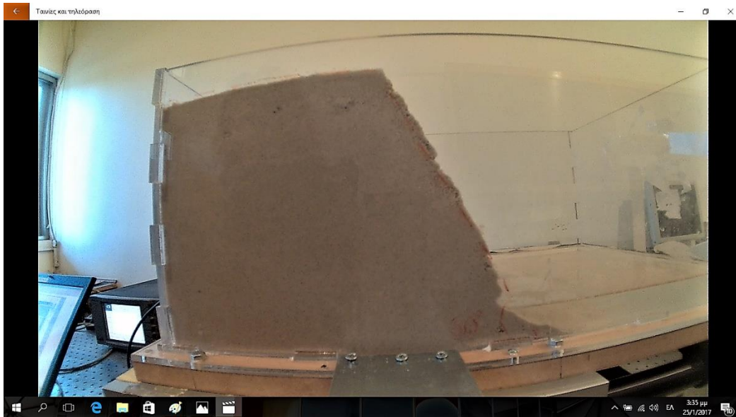
Εικόνα 125 Το πρανές πριν τη φόρτιση. Και η πρώτη εικόνα αναφοράς.
