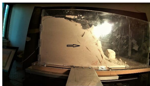
Εικόνα 102 Μηχανισμός Αστοχίας Πρανούς Figure 102 Slope Failure Mechanism
