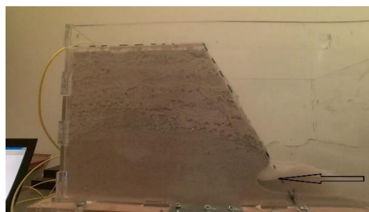
Εικόνα 84 Μηχανισμός Υποσκαφής στον Πόδα του πρανούς Figure 84 Undercut mechanism at the foot of the slope
