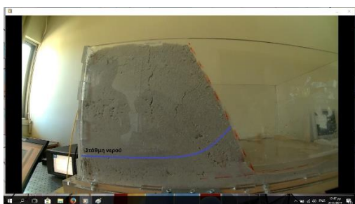
Εικόνα 235 Αρχική κατάσταση πρανούς προ Φόρτισης Figure 235 Initial Slope Condition before Loading
