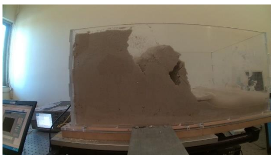
Εικόνα 266 Αστοχία Πρανούς, Figure 266 Slope Failure
