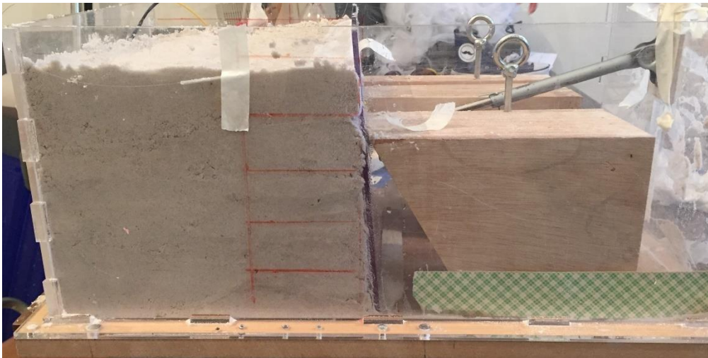
Εικόνα 294 Κατασκευή του Πειραματικού Μοντέλου με τη Βοήθεια Καλουπιού
