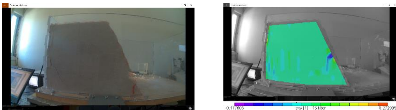
Εικόνα 325 Στιγμιότυπο της φόρτισης / Διατμητικές Παραμορφώσεις \epsilon_{xy} κατά το πρόγραμμα Vic 2D χωρίς επεξεργασία του εύρους των τιμών των παραμορφώσεων
