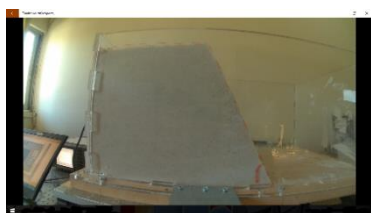
Εικόνα 188 Στιγμιότυπο της φόρτισης / Διατμητικές Παραμορφώσεις e_{xy} κατά το πρόγραμμα Vic 2D χωρίς επεξεργασία του εύρους των τιμών των παραμορφώσεων / με κοινό εύρος τιμών παραμορφώσεων Figure 188 Snapshot of Slope during Loading / Shear Strain e_{xy} in the Vic 2D program without processing the range of strain values / with a common strain range
