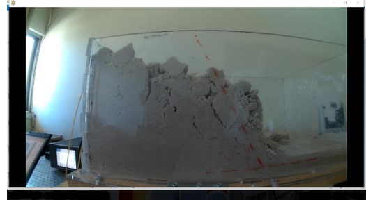
Εικόνα 238 Αστοχία Πρανούς Figure 238 Slope Failure
