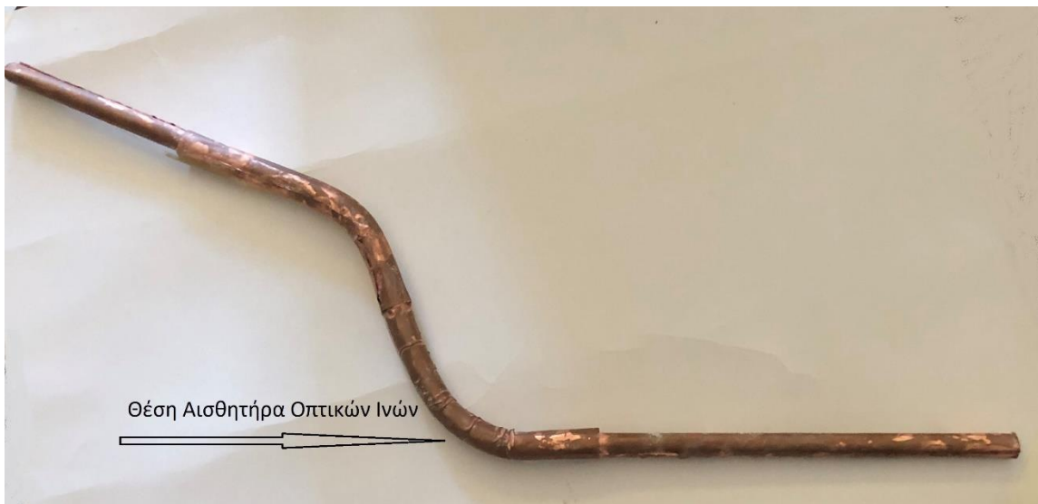
Εικόνα 229 Τελική Κατάσταση αγωγού μετά την επιβολή φόρτισης Figure 229 Final pipeline condition post Loading
