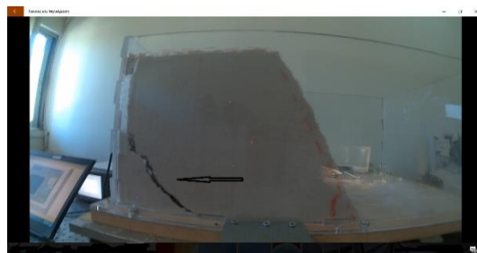
Εικόνα 187 Μηχανισμός Αστοχίας Πρανούς Figure 187 Slope Failure Mechanism
