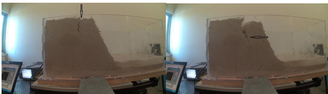
Εικόνα 264 Δημιουργία Εφελκυστικής Ρωγμής Figure 264 Initiating tensile cracks
