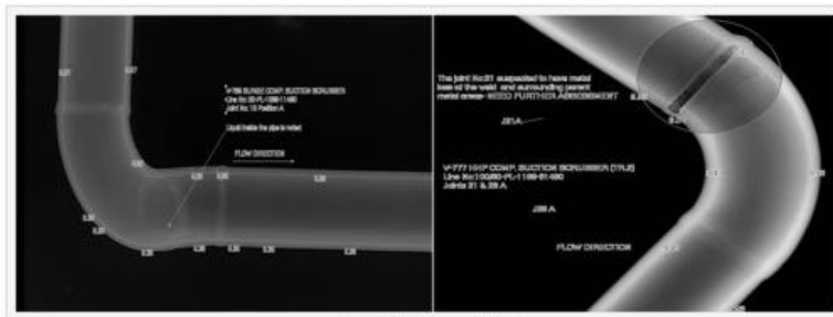
Εικόνα 13 Παράδειγμα ακτινογραφίας με εναπόθεση υλικού και απώλεια μετάλλου
