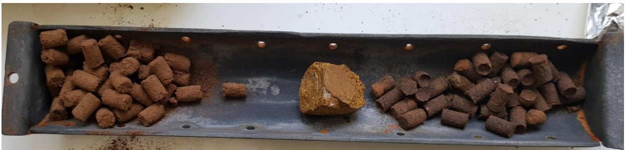
Εικόνα 4.2.4-1: Pellets τοποθετημένα στην ειδική υποδοχή (αριστερά είναι τα αναλογίας 80/20 και δεξιά τα αναλογίας 60/40)
