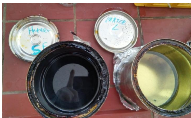
Εικόνα 4.4.1-1: Σκληρυντές HARTER (αριστερά είναι ο γρήγορος –fast- και δεξιά ο αργός –slow)
