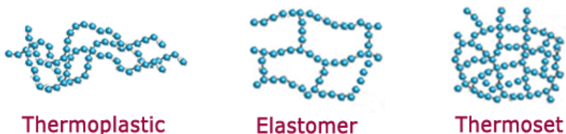
Εικόνα 1.8.4.i: Διάταξη αλυσίδων βάση θερμομηχανικής κατάταξης
