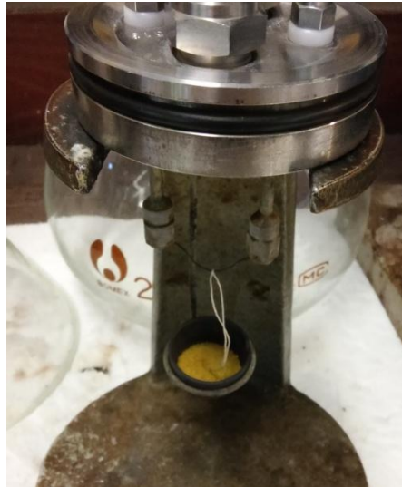
Εικόνα 5.3.2-1: Δείγμα τοποθετημένο στο εσωτερικό του όλμου
