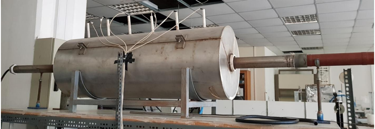
Εικόνα 4.2.4-3: Φούρνος πυρόλυσης με συνδεδεμένα θερμοστοιχεία
