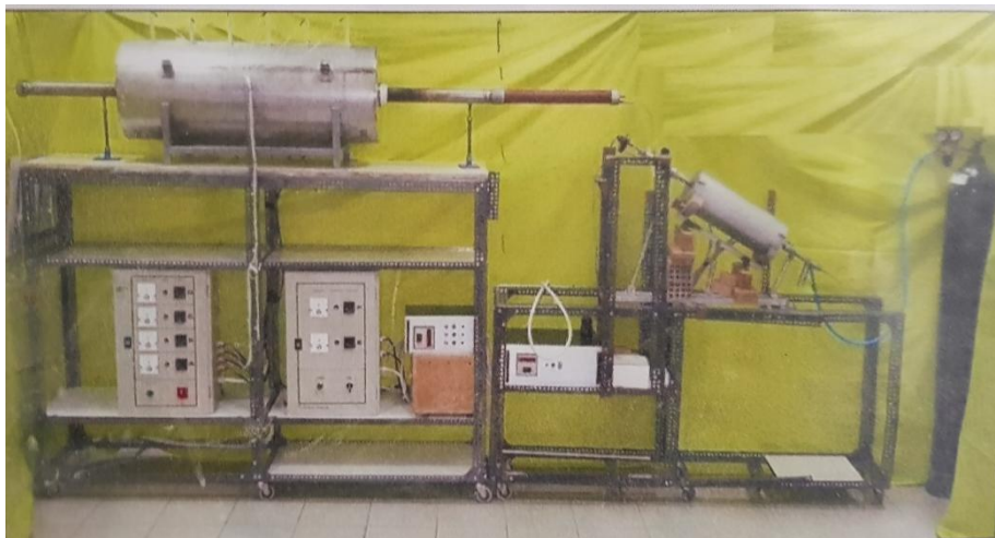
Εικόνα 4.2.4-2: Πιλοτική διάταξη ανθρακοποίησης και ενεργοποίησης ανθρακούχων προσροφητικών υλικών
