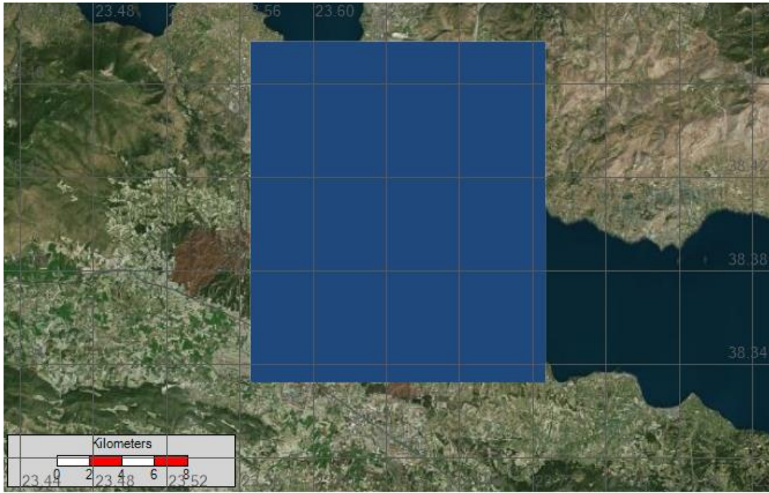
Εικόνα 4.10: Μικρός κάναβος στο λογισμικό Mohid Studio (δεν περιέχονται πολύγωνα που δεν υπολογίζεται βαθυμετρία)
