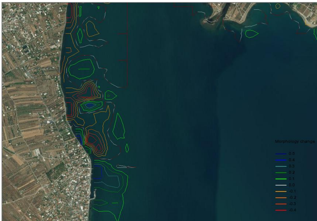
Σχήμα 5.12β: Μορφολογική εξέλιξη του πυθμένα (m) στο πέρας της προσομοίωσης στην περιοχή του λιμένα και των υφιστάμενων προβόλων στο μοντέλο CMS-Flow (με τη μορφή ισοδυναμικών καμπυλών)
