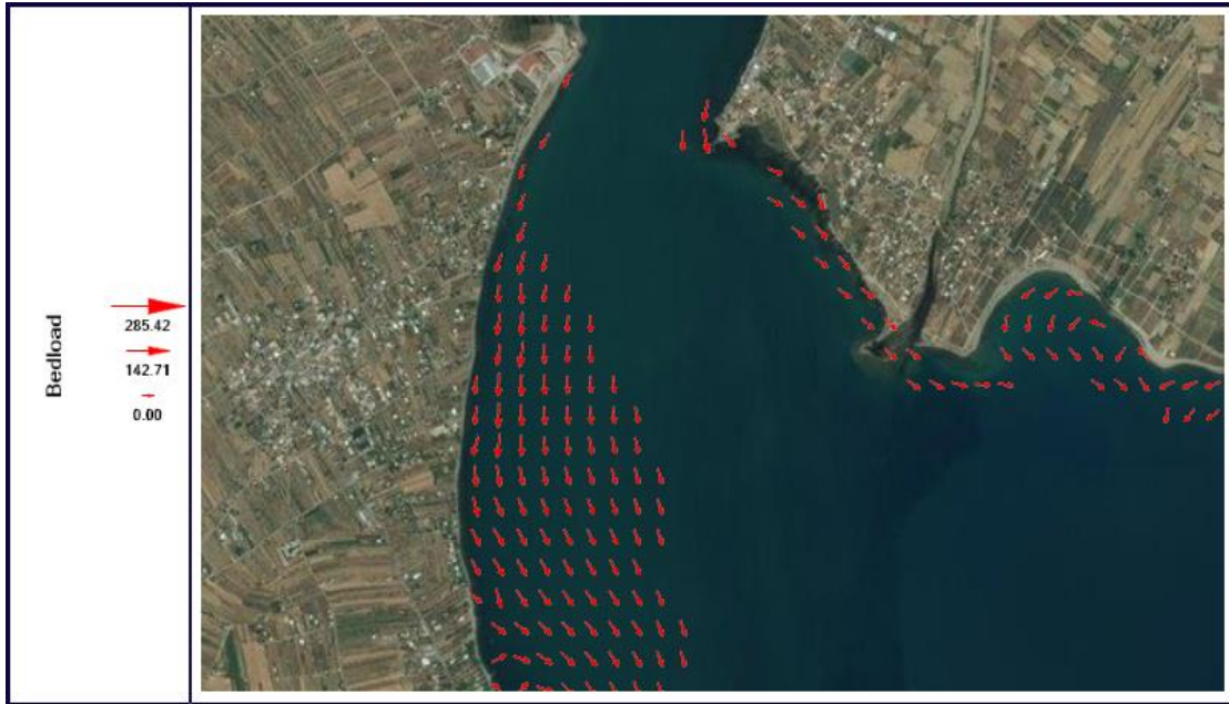
Σχήμα 5.17α: Χωρική κατανομή του φορτίου πυθμένα ( m^2/s ) στο πέρας της προσομοίωσης στην περιοχή του παραλιακού δρόμου στο μοντέλο Mohid Water
