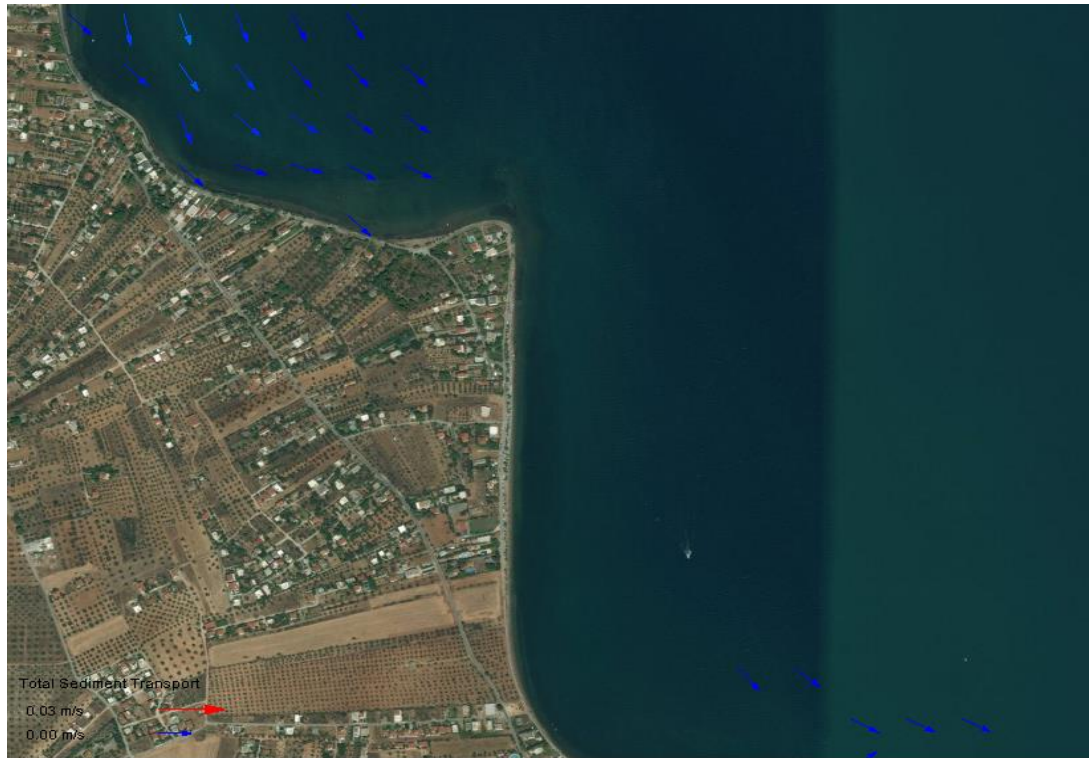
Σχήμα 5.11γ: Χωρική κατανομή της ολικής στερεομεταφοράς κατά xy (m/s) στο πέρας της προσομοίωσης στην περιοχή του κατώτερου ορίου της περιοχής μελέτης στο μοντέλο CMS-Flow
