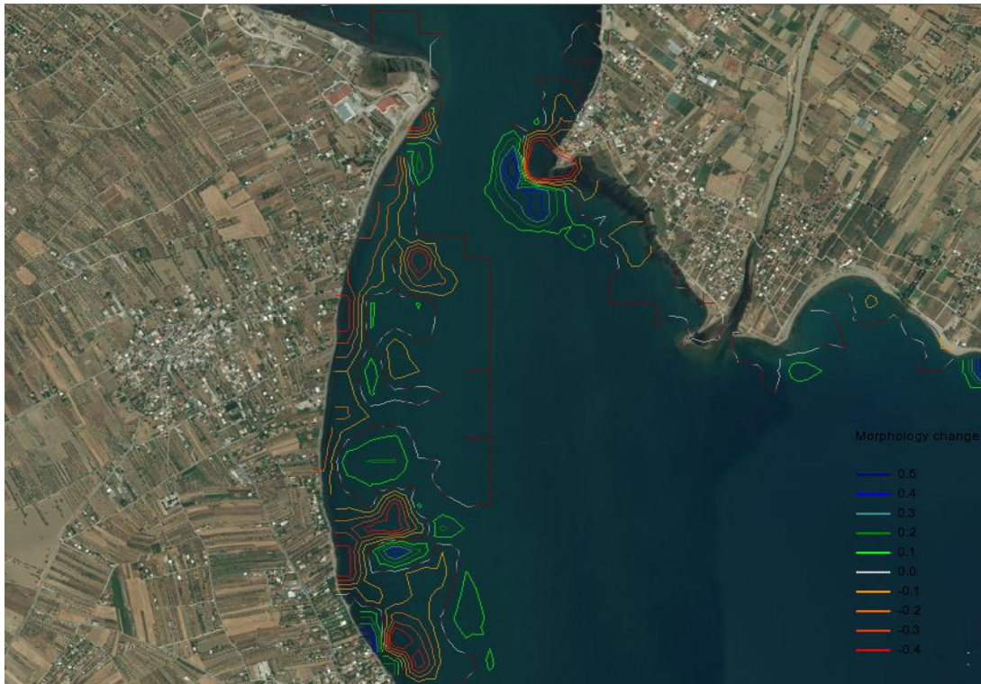
Σχήμα 5.12α: Μορφολογική εξέλιξη του πυθμένα (m) στο πέρας της προσομοίωσης στην περιοχή του παραλιακού δρόμου στο μοντέλο CMS-Flow (με τη μορφή ισοδυναμικών καμπυλών)
