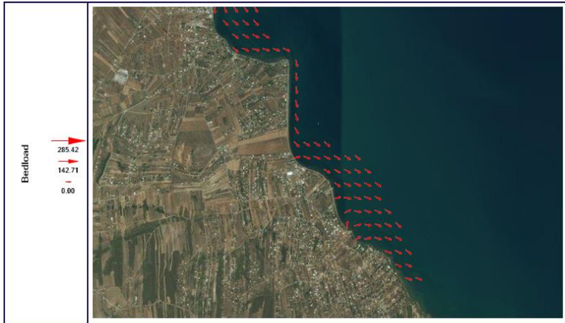
Σχήμα 5.17γ: Χωρική κατανομή του φορτίου πυθμένα ( m^2/s ) στο πέρας της προσομοίωσης στο κατώτερο όριο της περιοχής μελέτης στο μοντέλο Mohid Water
