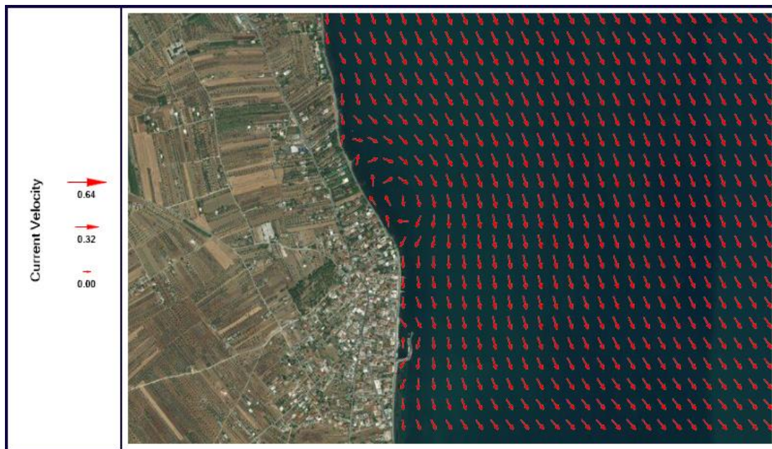
Σχήμα 5.16β: Χωρική κατανομή της ταχύτητας των ρευμάτων υν (m/s) στο πέρας της προσομοίωσης στην περιοχή του λιμένα και των υφιστάμενων προβόλων στο μοντέλο Mohid Water
