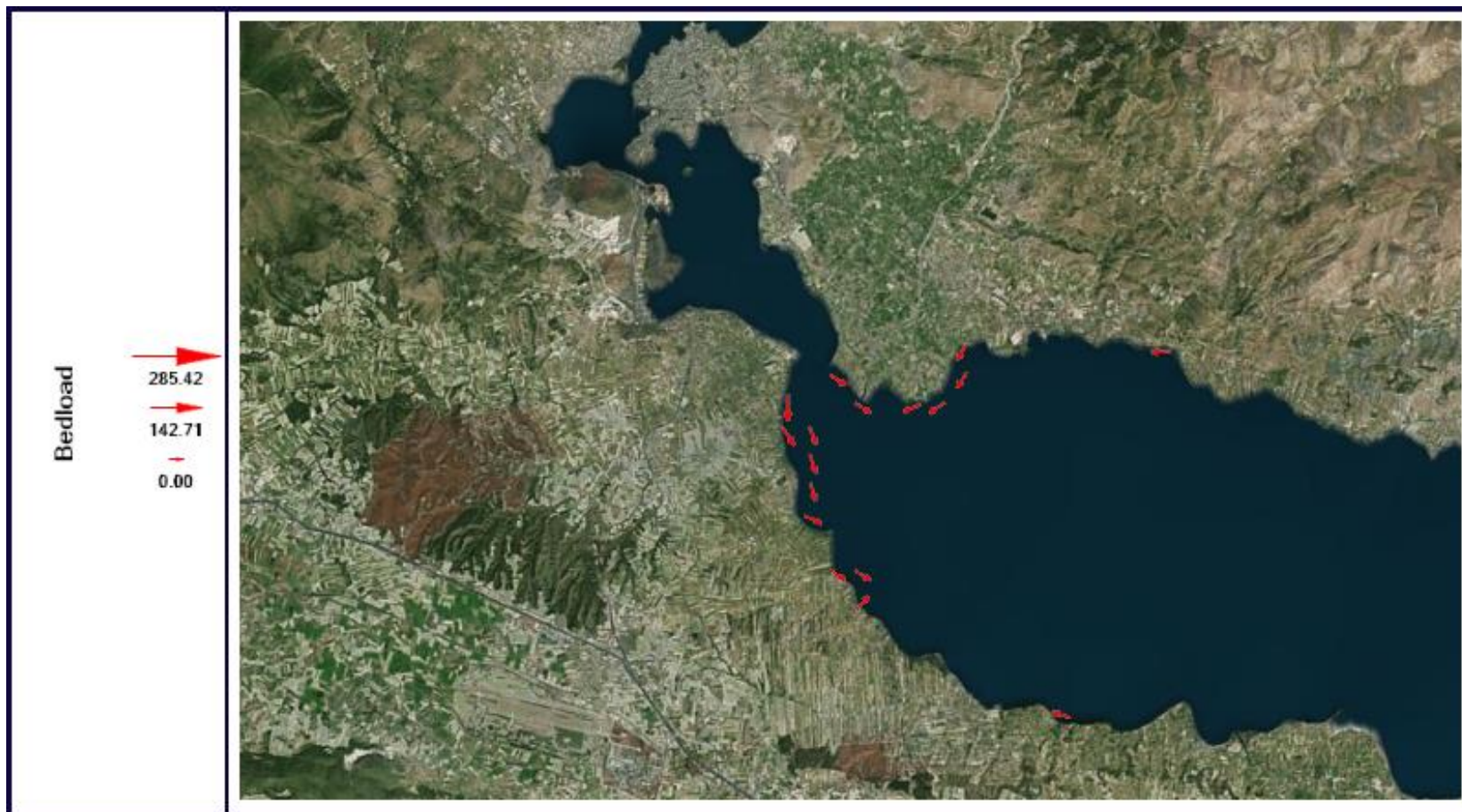
Σχήμα 5.17: Χωρική κατανομή του φορτίου πυθμένα στο πέρας της προσομοίωσης στο μοντέλο Mohid Water
