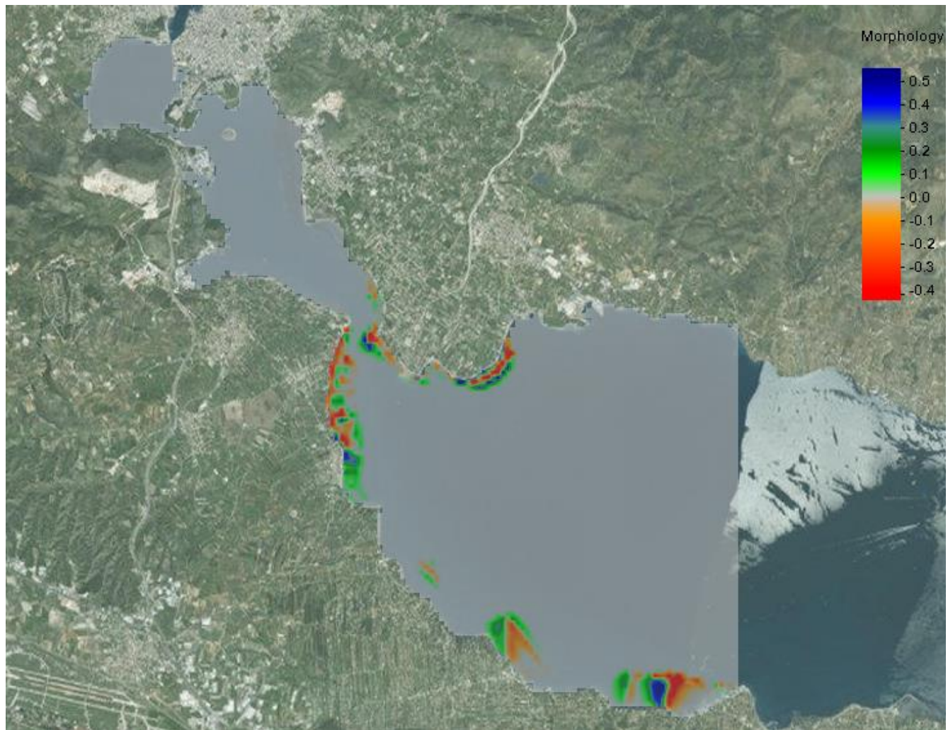
Σχήμα 5.12: Μορφολογική εξέλιξη του πυθμένα (m) στο πέρας της προσομοίωσης στο μοντέλο CMS-Flow
