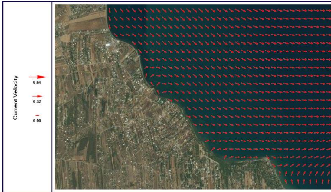
Σχήμα 5.16γ: Χωρική κατανομή της ταχύτητας των ρευμάτων u (m/s) στο πέρας της προσομοίωσης στο κατώτερο όριο της περιοχής μελέτης στο μοντέλο Mohid Water
