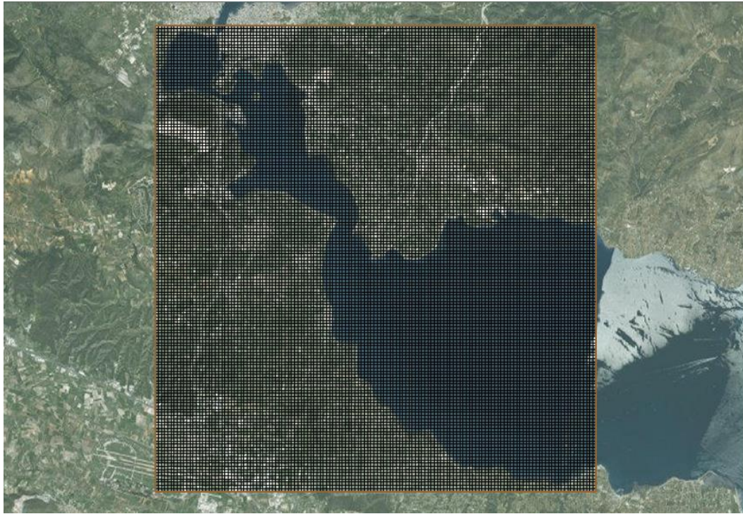
Εικόνα 4.8: Κάναβος πεπερασμένων στοιχείων στο λογισμικό CMS-Flow και CMS-Wave
