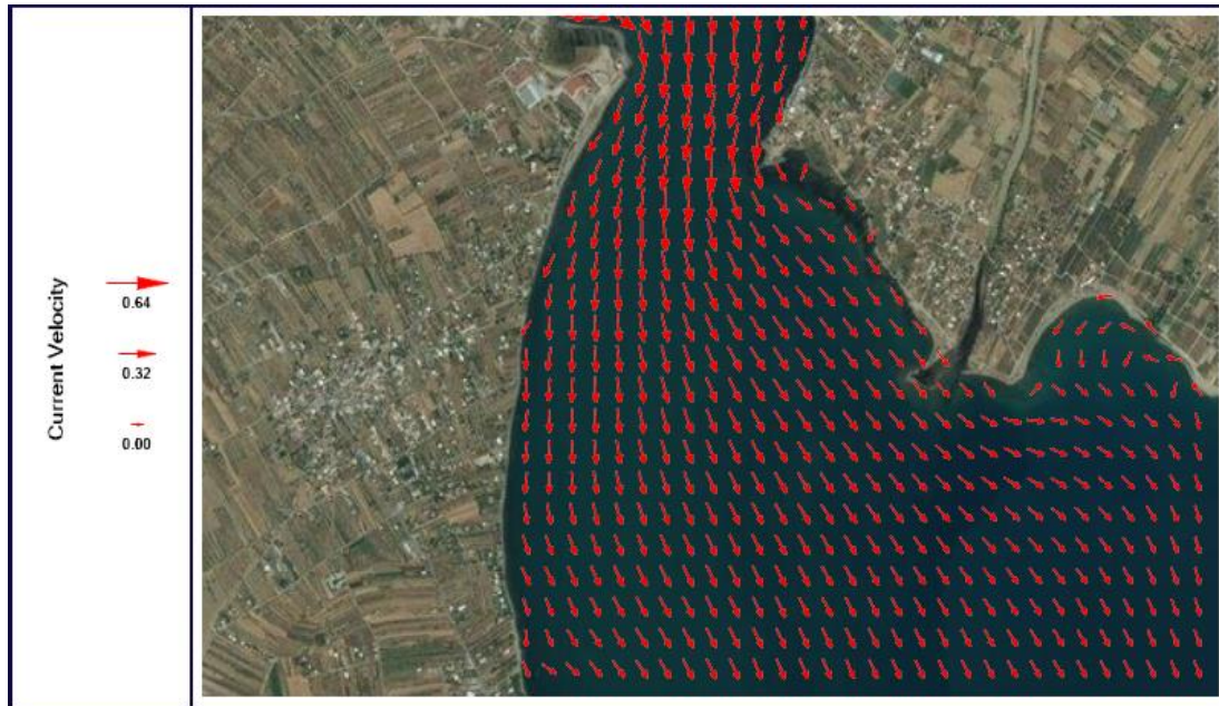
Σχήμα 5.16α: Χωρική κατανομή της ταχύτητας των ρευμάτων υν στο πέρας της προσομοίωσης στην περιοχή του παραλιακού δρόμου στο μοντέλο Mohid Water
