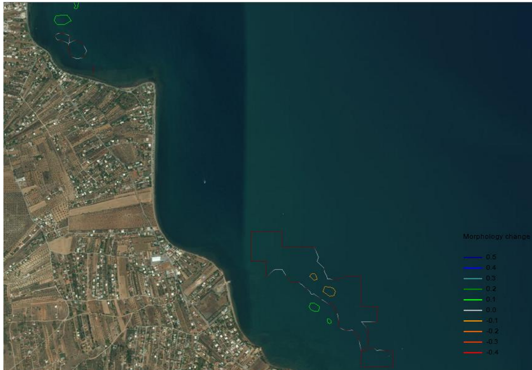
Σχήμα 5.12γ: Μορφολογική εξέλιξη του πυθμένα (m) στο πέρας της προσομοίωσης στην περιοχή του κατώτερου ορίου της περιοχής μελέτης στο μοντέλο CMS-Flow (με τη μορφή ισοδυναμικών καμπυλών)
