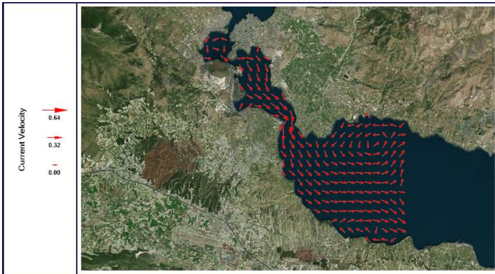
Σχήμα 5.16: Χωρική κατανομή της ταχύτητας των ρευμάτων u (m/s) στο πέρας της προσομοίωσης στο μοντέλο Mohid Water
