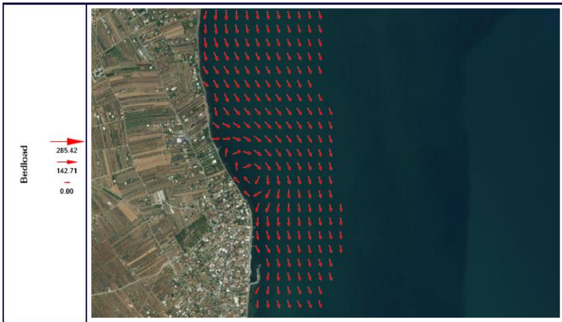
Σχήμα 5.17β: Χωρική κατανομή του φορτίου πυθμένα ( m^2/s ) στο πέρας της προσομοίωσης στην περιοχή του λιμένα και των υφιστάμενων προβόλων στο μοντέλο Mohid Water
