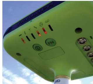
Εικόνα 3.1 Λυχνίες ένδειξης δέκτη JAVAD TRIUMPH Πηγή : [προσωπική συλλογή]
