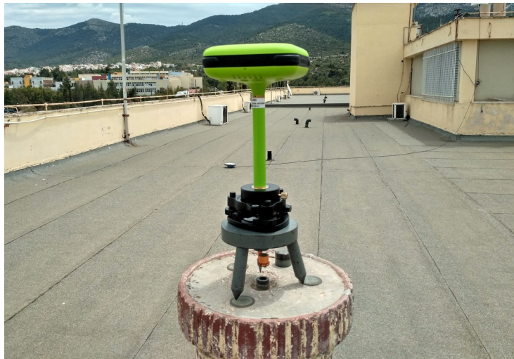
Εικόνα 3.3 Δέκτης Base στο βάθρο κτηρίου Λαμπαδαρίου
