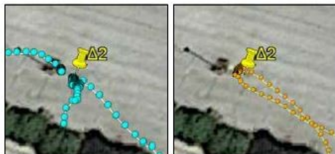
Εικόνα 5.3 Διαφορά στη θέση του κοινού σημείου εκκίνησης και τερματισμού \Delta 2 μεταξύ των δύο μεθόδων επίλυσης PPP-Kinematic (αριστερά) και Kinematic (δεξιά), διαδρομή δέκτη 04592 Πηγή: [Google Earth]
