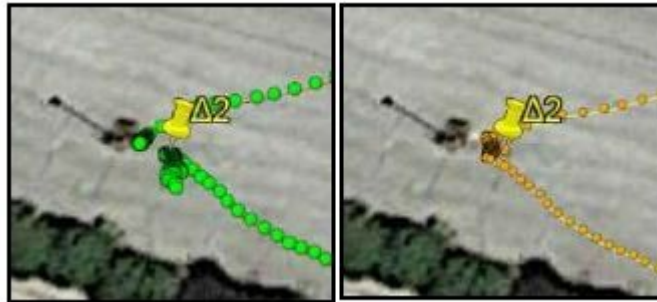
Εικόνα 5.1 Διαφορά στη θέση του κοινού σημείου εκκίνησης και τερματισμού \Delta 2 μεταξύ των δύο μεθόδων επίλυσης PPP-Kinematic (αριστερά) και Kinematic (δεξιά), διαδρομή δέκτη 04626 Πηγή: [Google Earth]
