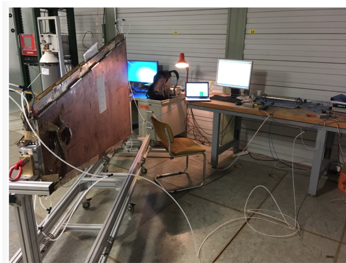
Σχήμα 8.11: Η πειραματική διάταξη μέτρησης της διαρροής αερίου του SM1-M0 με την μέθοδο FRL στο BB5 και η σχηματική της αναπαράσταση.
