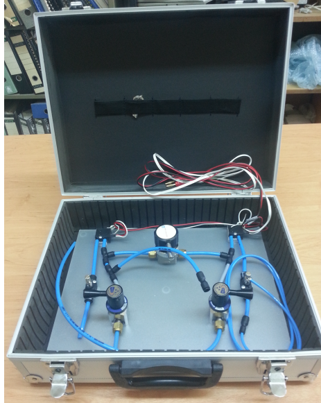
Σχήμα 6.13: Φορητή πειραματική διάταξη μέτρησης της διαρροής αερίου.
