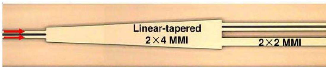
Σχήμα 5.37: Φωτογραφία (κάτοψη) ενός ολοκληρωμένου linear-tapered 90° optical hybrid
