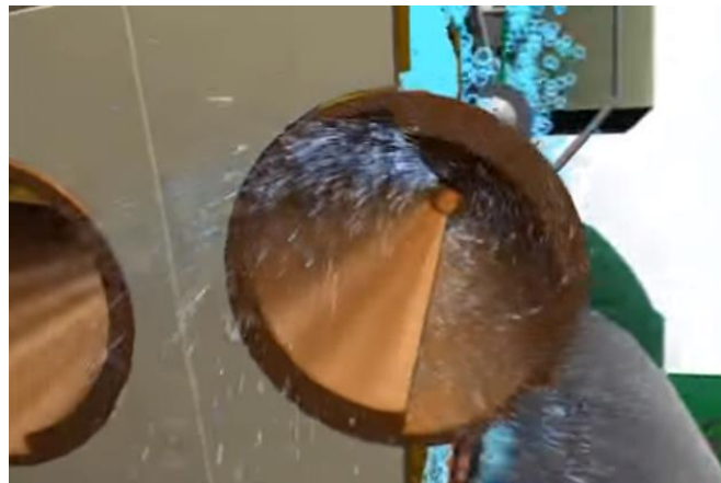
Σχήμα 2-47 Εισαγωγή του συμπιεσμένου αέρα στο πρώτο θάλαμο καύσης
