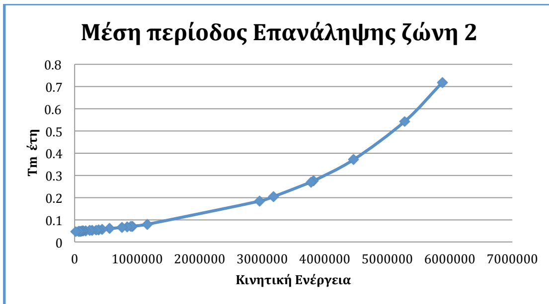
Σχήμα 63: Μέση περίοδος επανάληψης σε έτη-Κινητική Ενέργεια στη ζώνη 2
