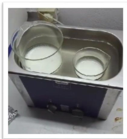
Εικόνα 6.3.1 Λουτρό υπερήχων κατά το στάδιο της προεπεξεργασίας του γάλακτος
