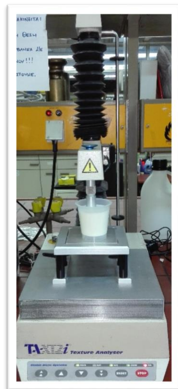
Εικόνα 6.5.3.1 Αναλυτής υφής Textue Analyzer TA-XT2i
