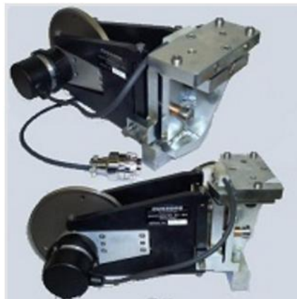
Εικόνα 4.4 Μετρητικός τροχός με τη συνδεσμολογία στήριξης του επί του φορέου.
