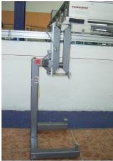
Εικόνα 4.2b Βραχίονας συγκράτησης δυναμόμετρου για τη διαδικασία της βαθμονόμησης.
