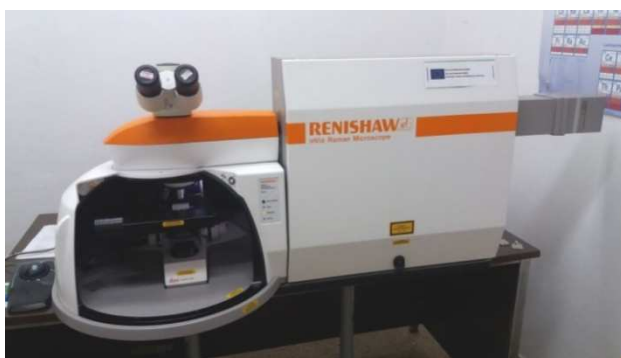
Εικ. 16. Η συσκευή Raman. Τοποθέτηση του μαρμαρίνου δοκιμίου προς εξέταση.
