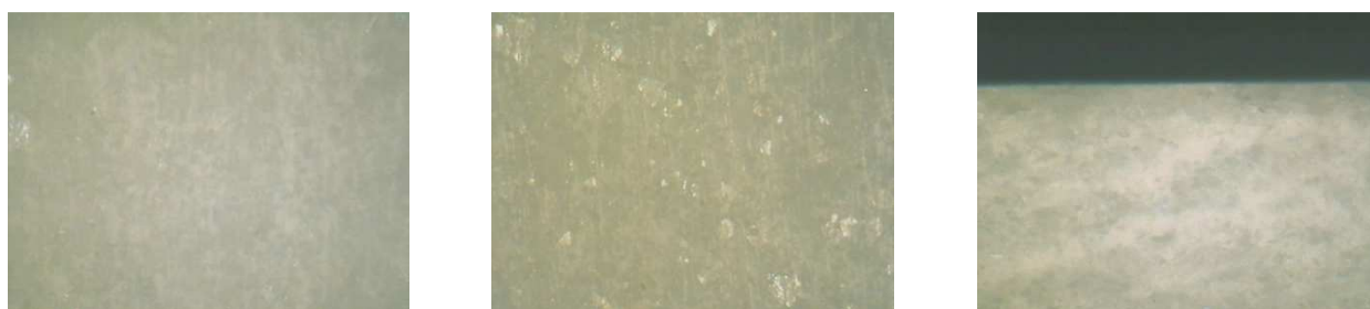
Εικ. 86. Η επιφάνεια του μαρμάρου χωρίς κατεργασία, μετά την ηχοβόλιση σε μεγέθυνση (50x).
