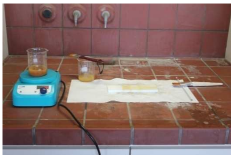
Εικ. 5. Κατά την κατεργασία των μαρμάρινων επιφανειών: Ανάδευση του αιωρήματος σε μαγνητικό αναδευτήρα.
