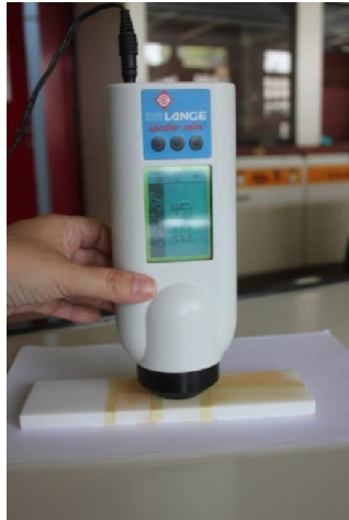
Εικ. 13. Φασματοφωτόμετρο τύπου Doctor Lange LM6 159-160.
