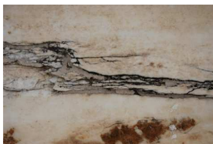
Εικ. 1. Αποσάθρωση αργιλοπυριτικής φλέβας.
