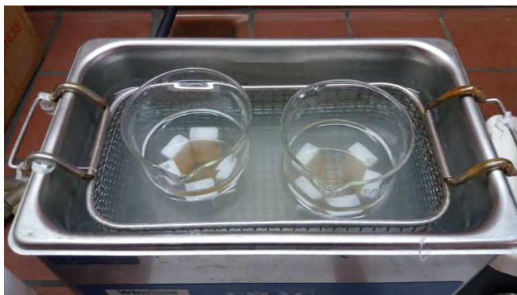
Εικ. 15. Κατά την ηχοβόλιση των δοκιμίων στο λουτρό υπερήχων.
