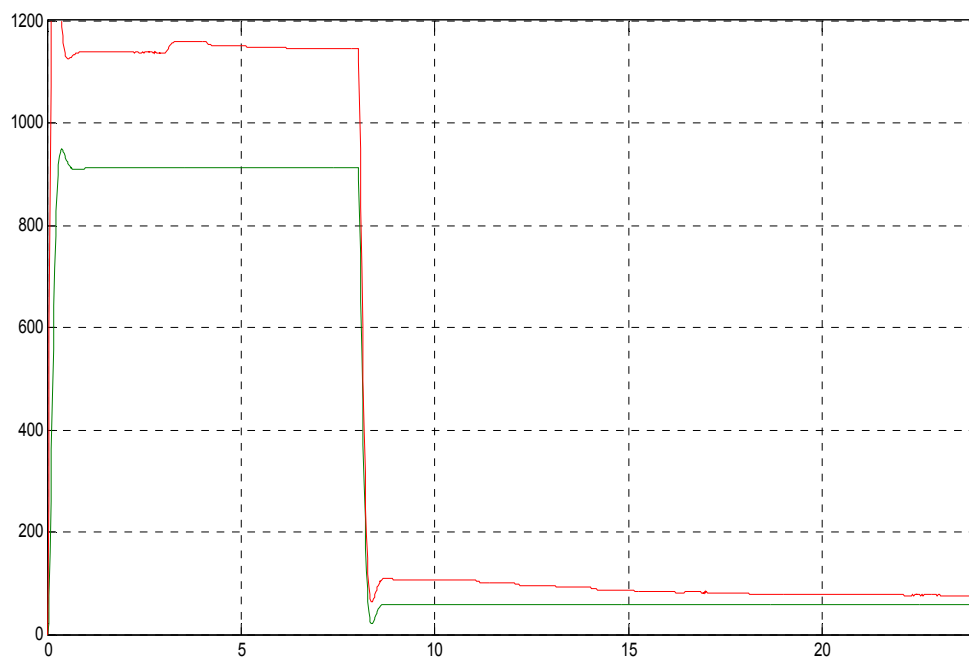
ΣΧΗΜΑ 3.11 ΙΣΧΥΣ ΕΙΣΟΔΟΥ-ΕΞΟΔΟΥ P_{IN}-P_{OUT} (W) ΣΥΝΑΡΤΗΣΗΙ ΤΟΥ ΧΡΟΝΟΥ T(SEC)
