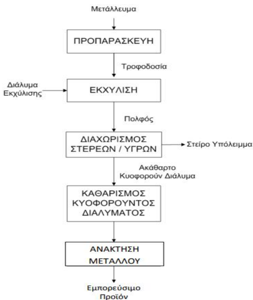
Σχήμα 2.1 Γενικό διάγραμμα ροής οποιασδήποτε υδρομεταλλουργικής μεθόδου
