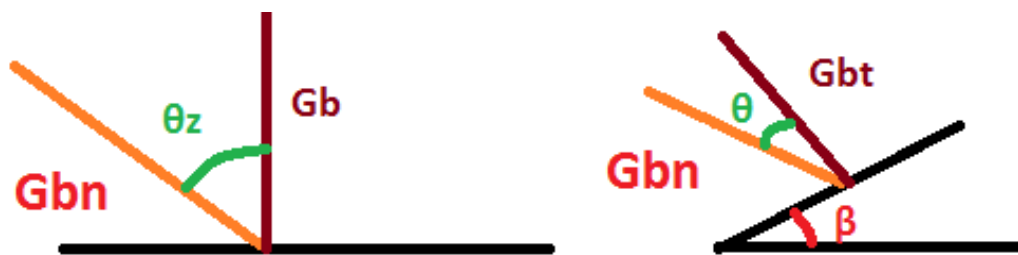
Εικόνα 2.7 Άμεσος ακτινοβολία οριζόντιας και κεκλιμένης επιφάνειας.
