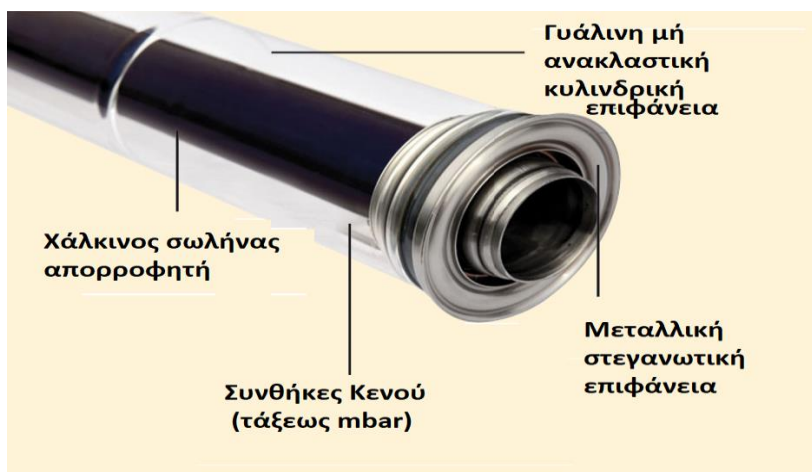
Εικόνα 3.3 Εξαρτήματα Σωλήνα Κενού [3.3]
