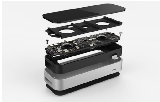
Εικόνα 2.6: Το εσωτερικό τμήμα της συσκευής Leap Motion
