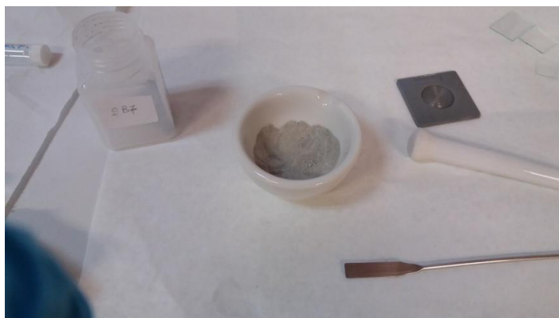
Εικόνα 3.9 Προετοιμασία δείγματος για την ανάλυση XRD
