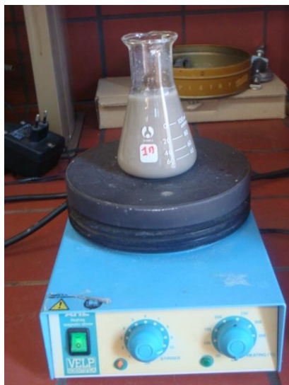
Εικόνα 3.23 Προσομοίωση δοκιμής έκπλυσης EN 12457/2 σε μαγνητικό αναδευτήρα
