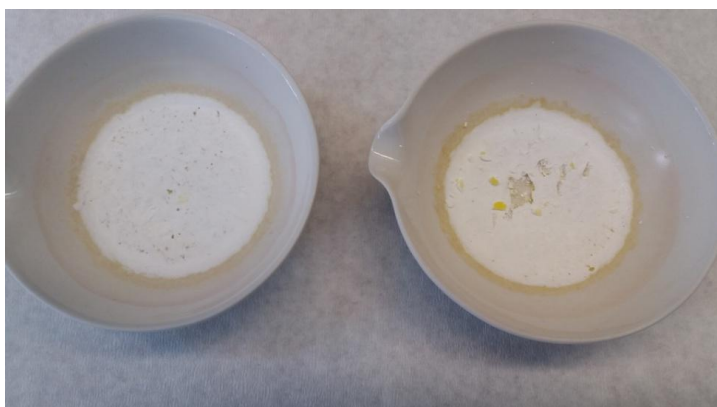
Εικόνα 4.11 Στερεό υπόλειμμα αλάτων κατά τη μέτρηση TDS του υγρού αποβλήτου της μεθόδου S_{10}W_0 για την ιπτάμενη τέφρα ΙΑ
