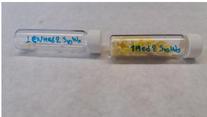
Εικόνα 4.12 Στερεό υπόλειμμα αλάτων κατά τη μέτρηση TDS του υγρού αποβλήτου της μεθόδου S_{10}W_0 (δεξιά) και στερεό υπόλειμμα αλάτων κατά τη μέτρηση TDS του εκπλύματος EN 12457/2 της επεξεργασμένης με τη μέθοδο S_{10}W_0 τέφρας ΙΑ (αριστερά)
