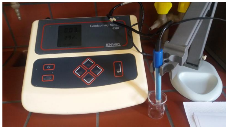
Εικόνα 3.14 Μέτρηση pH και αγωγιμότητας εκπλυμάτων
