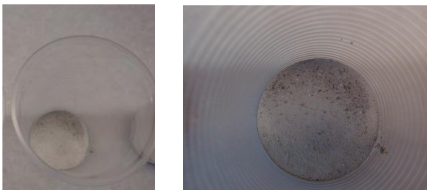
Εικόνα 4.5 Επεξεργασμένη τέφρα με τη μέθοδο S_7W_0 μετά την επεξεργασία με ασβέστη
