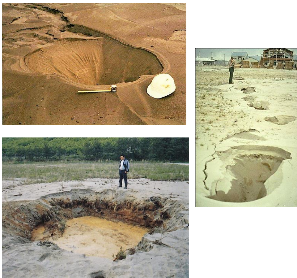
Σχήμα 1.14: Εμφάνιση κρατήρες άμμου σε ρευστοποιημένα εδάφη στις ΗΠΑ (Loma Prieta, 1989) (πάνω αριστερά) και στην Ιαπωνία (Niigata, 1964) (κάτω αριστερά και δεξιά).
