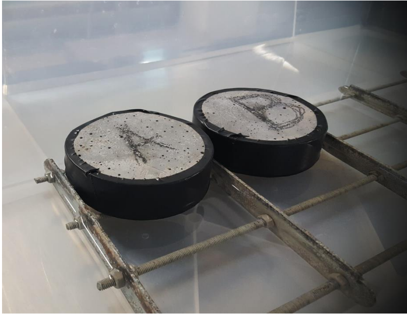
Εικόνα 4.9: Δοκίμια κατά την διάρκεια του πειράματος της τριχοειδούς απορρόφησης
