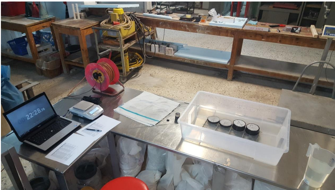
Εικόνα 4.8: Διεξαγωγή πειράματος τριχοειδούς απορρόφησης
