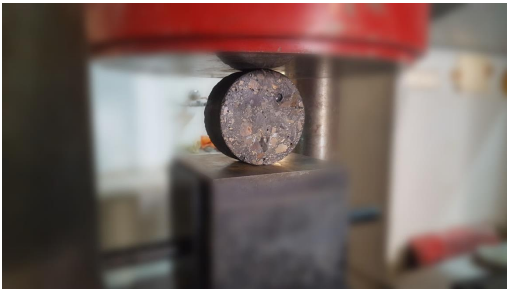
Εικόνα 4.13: Διάρρηξη του δοκιμίου
