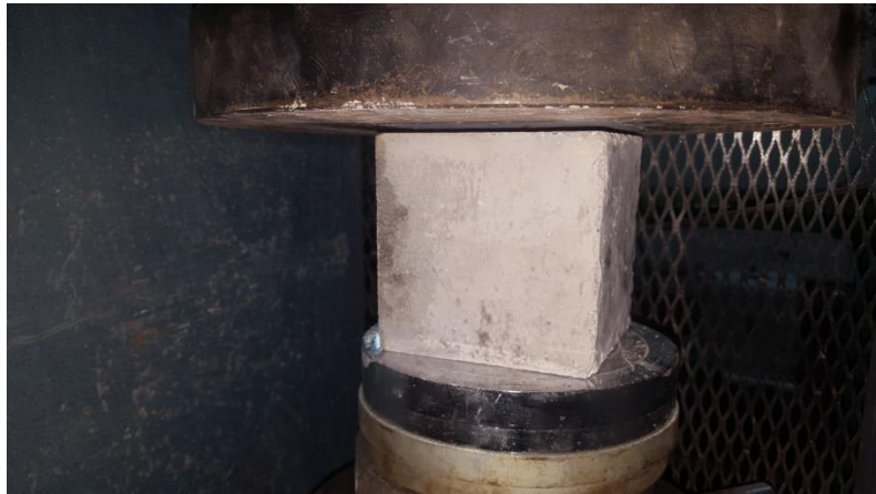
Εικόνα 4.4: Διάταξη δοκιμής σε μονοαξονική θλίψη για τον προσδιορισμό της θλιπτικής αντοχής f_c
