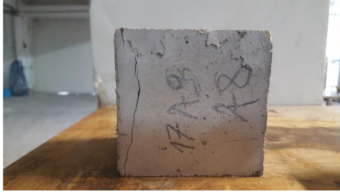
Εικόνα 4.5: Δοκίμιο μετά τη δοκιμή θραύσης
