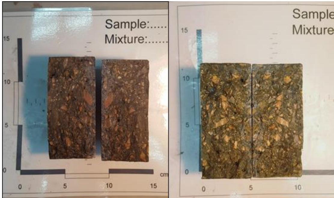
Εικόνα 4.16: Μέτρηση του βάθους διείσδυσης των χλωριόντων
