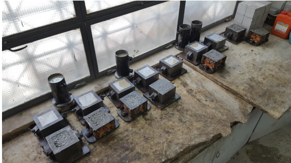
Εικόνα 4.1: Παρασκευή κυβικών και κυλινδρικών δοκιμών διαστάσεων 1000x100x100 mm και 200x100 mm αντίστοιχα
