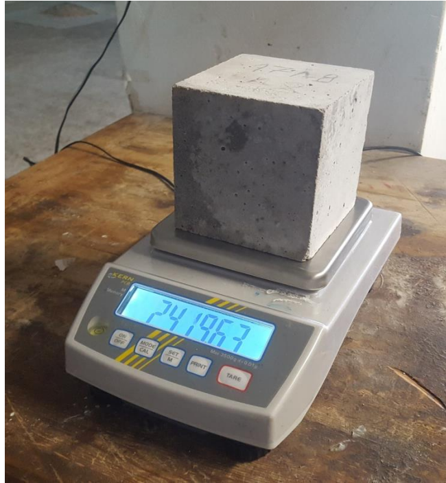
Εικόνα 4.3: Μέτρηση βάρους κυβικού δοκιμίου
