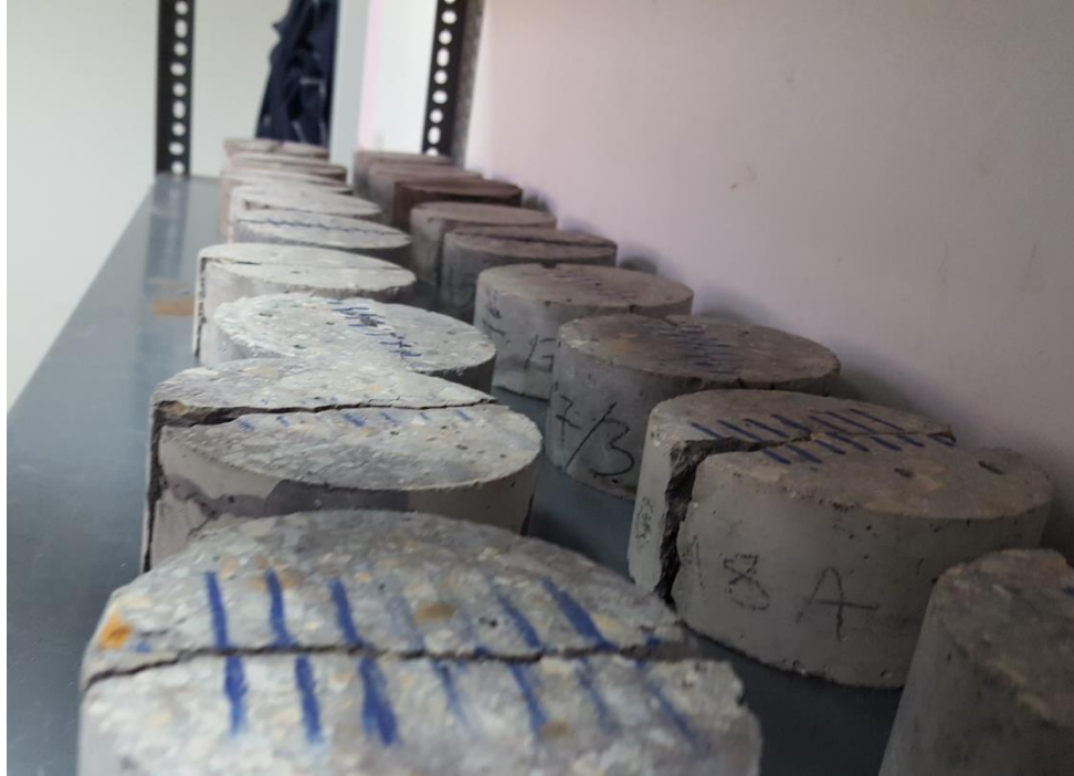
Εικόνα 4.14: Δοκίμια μετά τη διάρρηξη
