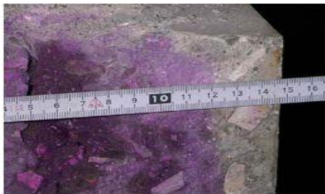
Εικόνα 1.6: Εκτίμηση βάθους ενανθράκωσης σκυροδέματος μετά από ψεκασμό με διάλυμα φαινολοφθαλεΐνη
