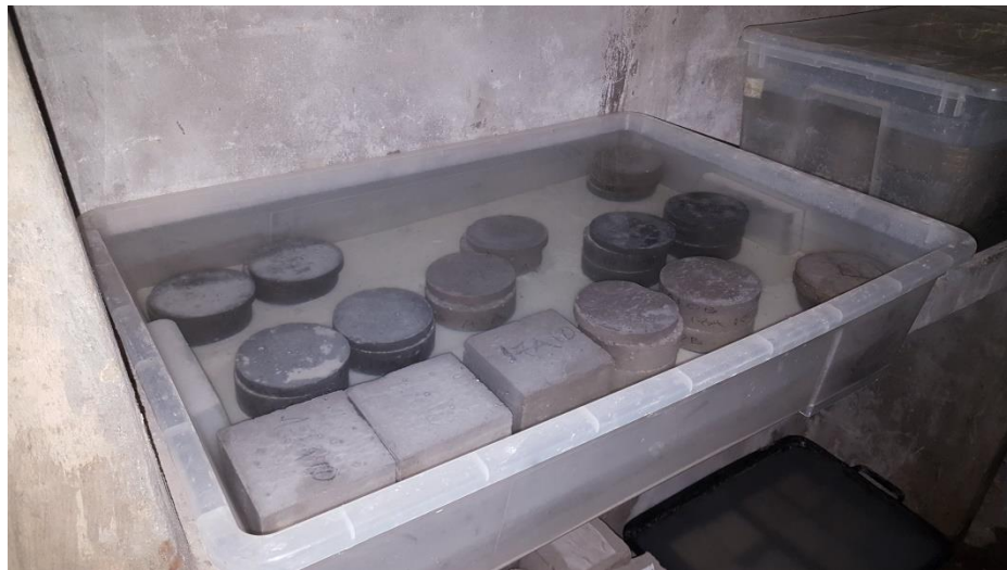
Εικόνα 4.2: Συντήρηση κυβικών και κυλινδρικών δοκιμών σε νερό
