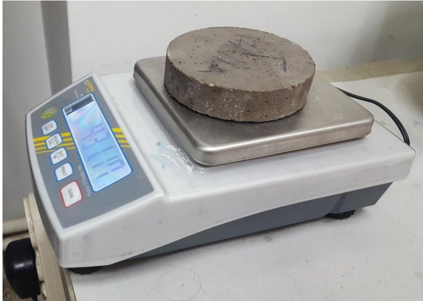
Εικόνα 4.6: Μέτρηση μάζας επιφανειακώς στεγνού δοκιμίου
