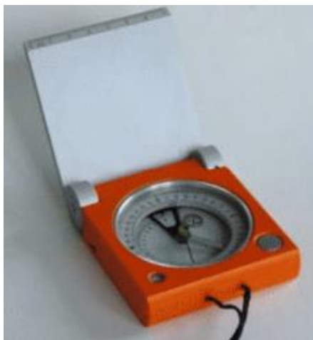
Εικόνα 4.1: Η γεωλογική πυξίδα Clar
