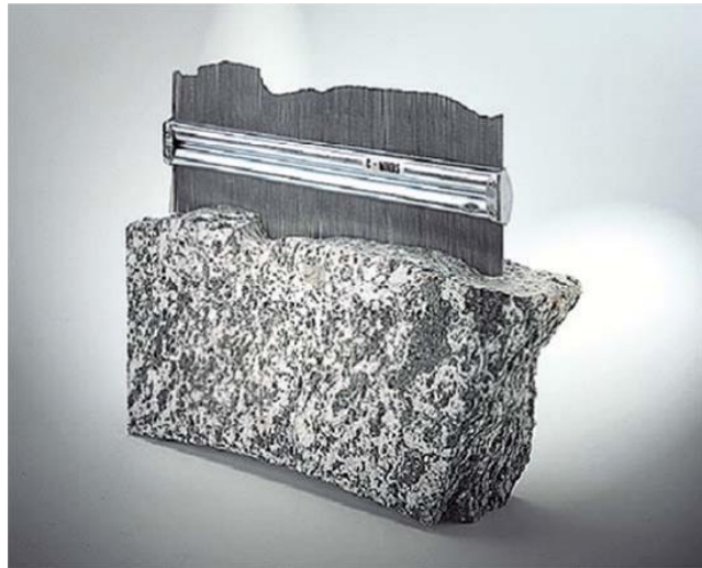
Εικόνα 3.12: Φωτογραφία μηχανικού προφιλόμετρου (Νομικός 2015)
