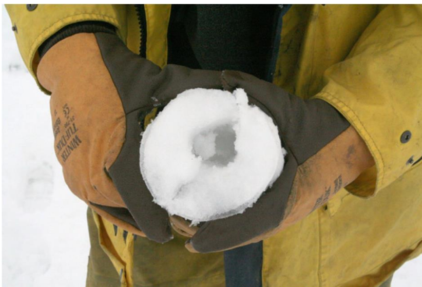
Σχήμα 2.13: Παγετός περιμετρικά στύλου πυλώνα, διαμέτρου 13cm κατά προσέγγιση [Klinger, 2011]
