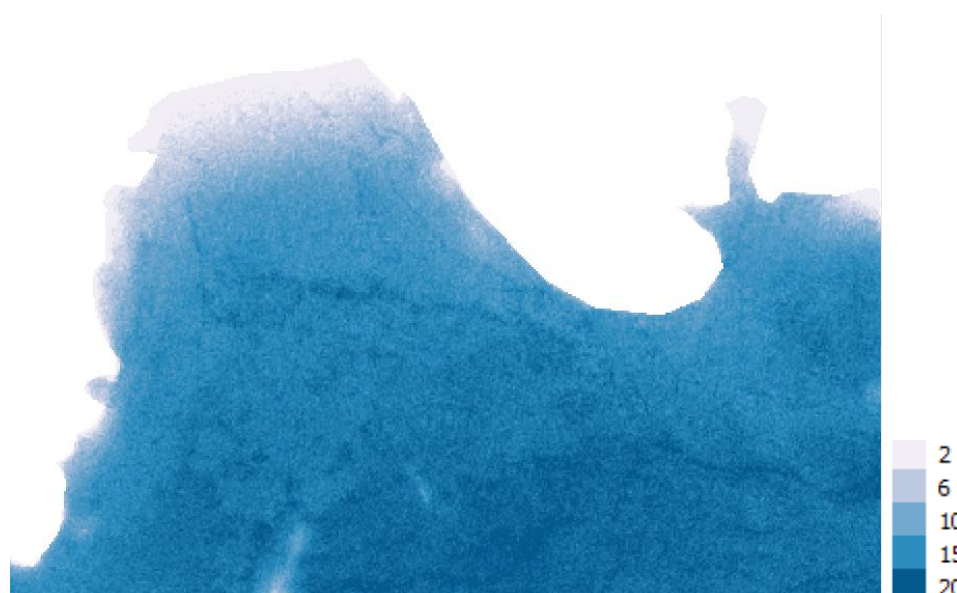
Σχήμα 44. Βαθυμετρική εικόνα μετά την εφαρμογή του μοντέλου Stumpf στην εικόνα του Sentinel 2
