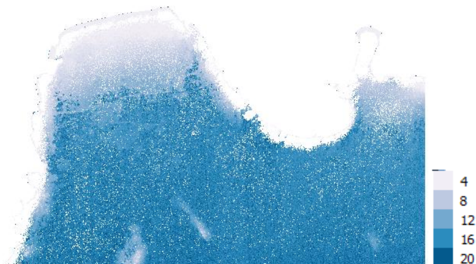
Σχήμα 45. Βαθυμετρική εικόνα μετά την εφαρμογή του μοντέλου Lyzenga στην εικόνα του WV2
