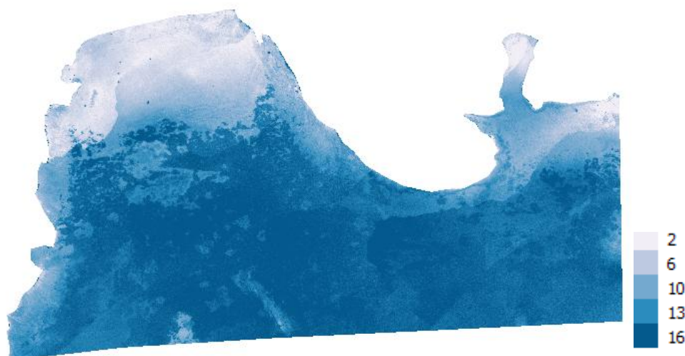
Σχήμα 49. Βαθυμετρική εικόνα μετά την εφαρμογή του μοντέλου Stumpf στην αεροφωτογραφία
