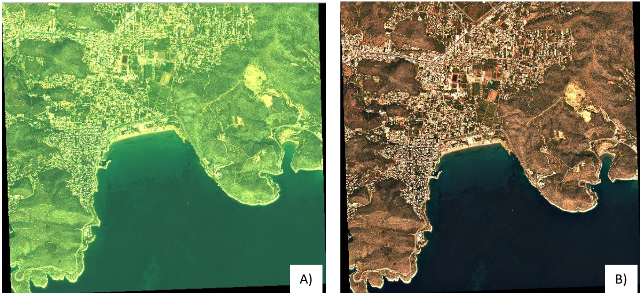
Σχήμα 17. Α) Η αρχική εικόνα Worldview-2 σε έγχρωμο σύνθετο 532, Β) η τελική ατμοσφαιρικά διορθωμένη εικόνα σε έγχρωμο σύνθετο 532 RGB
