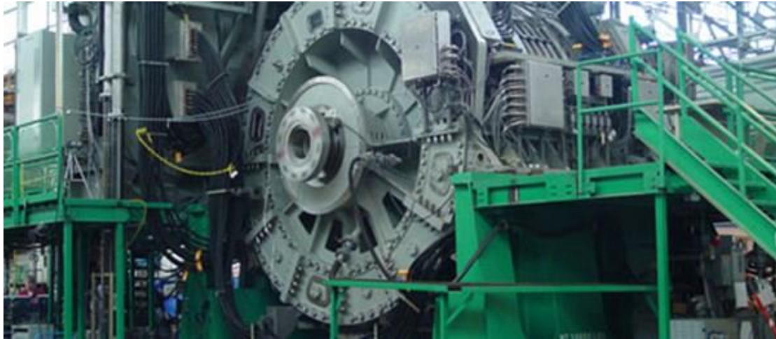
Εικόνα 3.11: Ναυτικός ηλεκτροκινητήρας ισχύος 36.5 MW, ABB 2011
