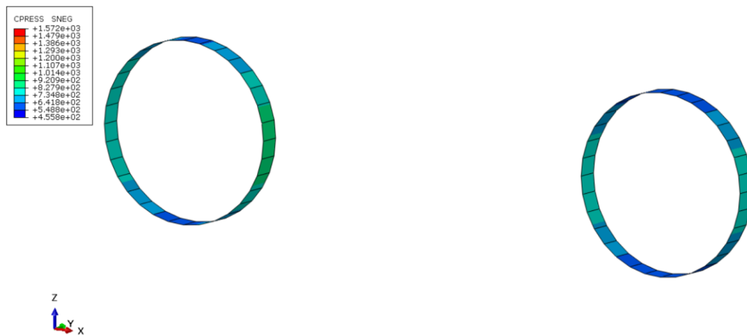
Εικόνα 4.3: Κατανομή των φορτίων περιμετρικά της υποστήριξης της «πρώτης» (αριστερά) και «δεύτερης» (δεξιά) σήραγγας μετά την ολοκλήρωση της εκσκαφής των δύο κλάδων (STEP 160) σε μία ενδιάμεση διατομή στη θέση Y=40m για εφαρμογή πλάτους πυλώνα W=2.0D=16m σε δυσμενείς γεωτεχνικές συνθήκες ( \sigma_{cm}/\rho_o=0.22 )
