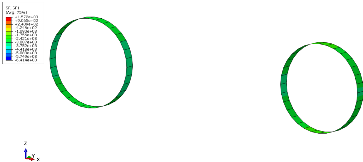
Εικόνα 4.6: Κατανομή των αξονικών δυνάμεων περιμετρικά της υποστήριξης της «πρώτης» (αριστερά) και «δεύτερης» (δεξιά) σήραγγας μετά την ολοκλήρωση της εκσκαφής και των δύο κλάδων (STEP 160) σε μία ενδιάμεση θέση ( Y=40m ) για εφαρμογή πλάτους πυλώνα W=2D=16m σε δυσμενείς γεωτεχνικές συνθήκες ( \sigma_{cm}/\rho_o=0.22 )
