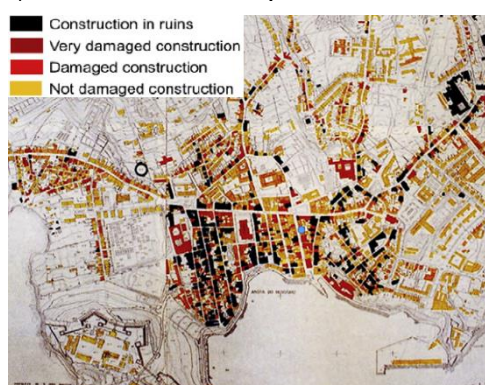
Εικόνα 3-82: Στάθμες κτιριακών βλαβών μετά τον σεισμό του 1980 στην Angra do Heroísmo. (Fagundes et al., 2017)
