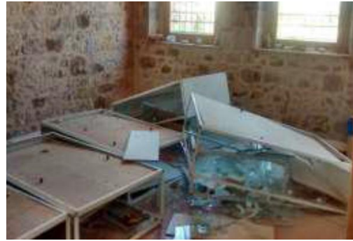
Εικόνα 5-12: Καταρρεύσεις προθηκών στο Μουσείο Φυσικής Ιστορίας Λέσβου μετά τον σεισμό της 12 ης Ιουνίου 2017 (Ενημερωτικό Σημείωμα Κλιμακίου ΟΑΣΠ, 2017)
