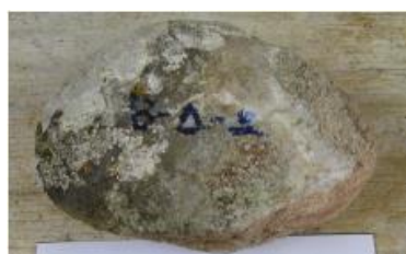
Εικόνα 6-37: Λίθος τυμπάνου (α) αρχική κατάσταση, μετά την δειγματοληψία (β) σε κατάσταση διαμόρφωσης δοκιμών στο εργαστήριο, αμέσως πριν την δοκιμή μονοαξονικής θλίψης (γ) μετά την δοκιμή θλίψης
