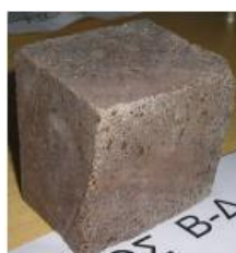
Εικόνα 6-37: Λίθος τυμπάνου (α) αρχική κατάσταση, μετά την δειγματοληψία (β) σε κατάσταση διαμόρφωσης δοκιμών στο εργαστήριο, αμέσως πριν την δοκιμή μονοαξονικής θλίψης (γ) μετά την δοκιμή θλίψης
