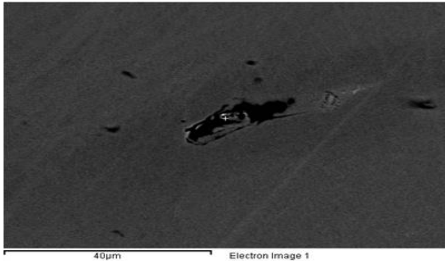
Εικόνα 4.5 Ηλεκτρονική μικρογραφία της μικροδομής της ζώνης συγκόλλησης BES x1000. Οι μαύρες περιοχές αποτελούν πόρους στην συγκόλληση.
