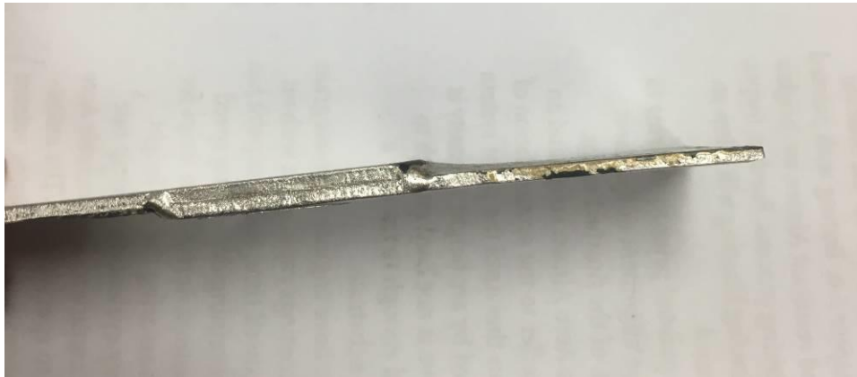
Εικόνα 3.12 Αποτέλεσμα της συγκόλλησης. Πλήρωση του διάκενου με τήξη των υλικών.
