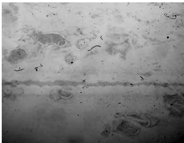
Εικόνα 4.34 Εικόνα οπτικού μικροσκοπίου για το δοκίμιο που υπέστη συγκόλληση με υλικό πλήρωσης BNi-9
