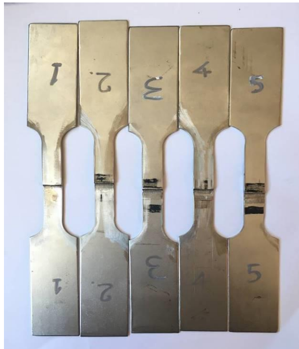
Εικόνα 3.13 Συγκολλημένα δοκίμια εφελκυσμού.
