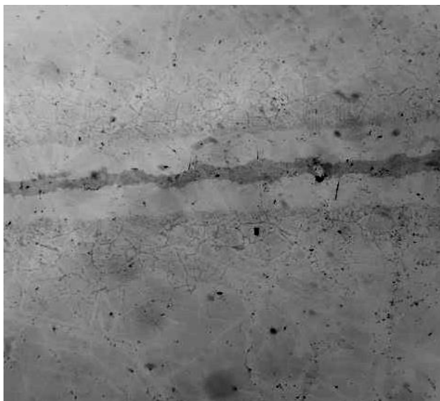
Εικόνα 4.30 Εικόνα οπτικού μικροσκοπίου για το δοκίμιο που υπέστη συγκόλληση με υλικό πλήρωσης AMS 4776.
