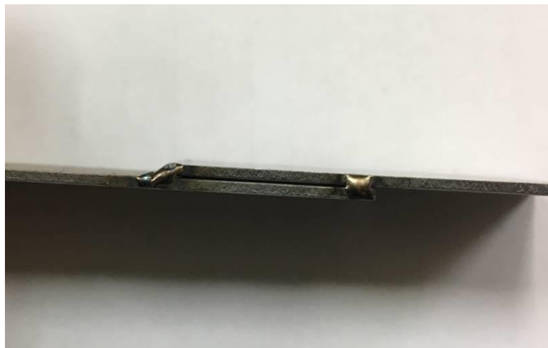
Εικόνα 3.7 Σχηματιζόμενο διάκενο περίπου 0.004” μετά την αφαίρεση του λεπτού ελάσματος
