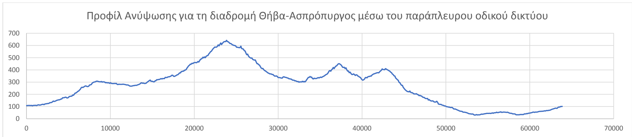
Διάγραμμα 7: Προφίλ ανύψωσης για τη διαδρομή Θήβα-Ασπρόπυργος μέσω του παράπλευρου οδικού δικτύου.
