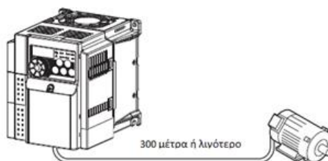
Σχήμα 2.6 Συνολικό μήκος καλωδίου σύνδεσης inverter-κινητήρα
