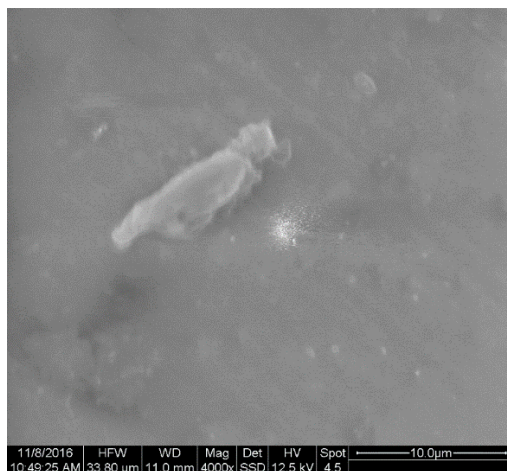
Σχήμα 2. Τυπική μορφή nanoribbon γραφενίου (GNP) (Seretis et al. 2017a).
