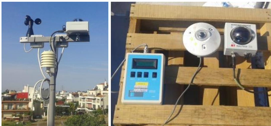
Σχήμα 7-11: Αισθητήρας ακτινοβολίας, ταχύτητας ανέμου και θερμοκρασίας αέρα περιβάλλοντος (αριστερά). Έλεγχος μετρήσεων ηλιακής ακτινοβολίας (δεξιά)
