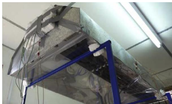
Σχήμα 2-11 : Δέκτης με πολλαπλούς σωλήνες σε κοιλότητα σε εργαστήριο [75]
