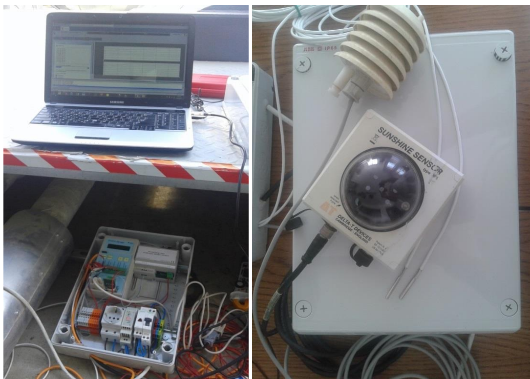
Σχήμα 8-10: Δειγματοληψία στο πεδίο και απεικόνιση δεδομένων μέσω υπολογιστή (αριστερά) και μετρητικά όργανα πριν την τοποθέτησή τους στο ηλιακό πεδίο (δεξιά)
