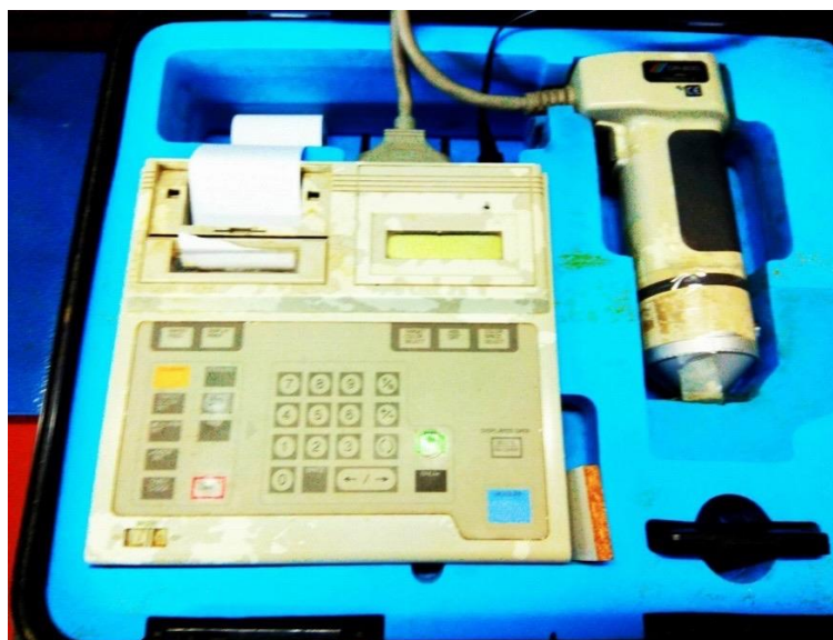
Εικόνα 5 Χρωματόμετρο CR-200 των εταιριών Konica-Minolta
