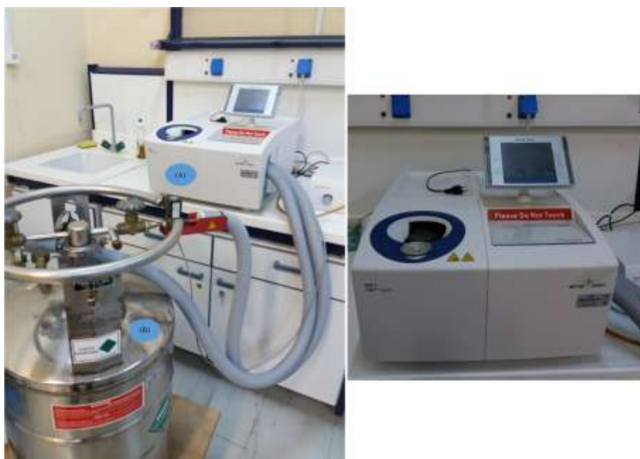
Εικόνα 3. 4: Πειραματική διάταξη DSC: (A) Κύρια μονάδα DSC (φούρνος και πίνακας ελέγχου), (B) σύστημα ψύξης, για παροχή υγρού αζώτου.
