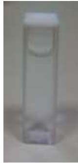
Εικόνα 5. 1: Η ιδανική ποσότητα διαλύματος που θα πρέπει να εισέρχεται στην τετράγωνη κυψελίδα.
