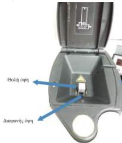
Εικόνα 5. 2: Απεικόνιση του κατάλληλου τρόπου τοποθέτησης της κυψελίδας στο DLS.
