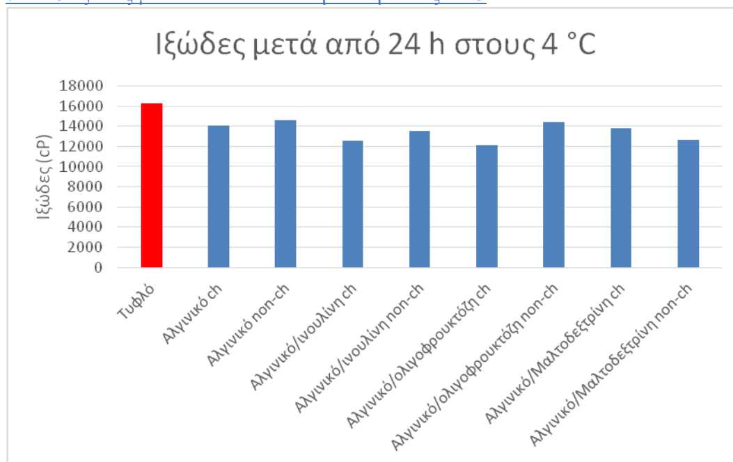
Διάγραμμα 7.32 Ιξώδες δειγμάτων 2 ης πειραματικής σειράς και τυφλού δείγματος γιαουρτιού μετά από 24 h αποθήκευση στους 4 °C
