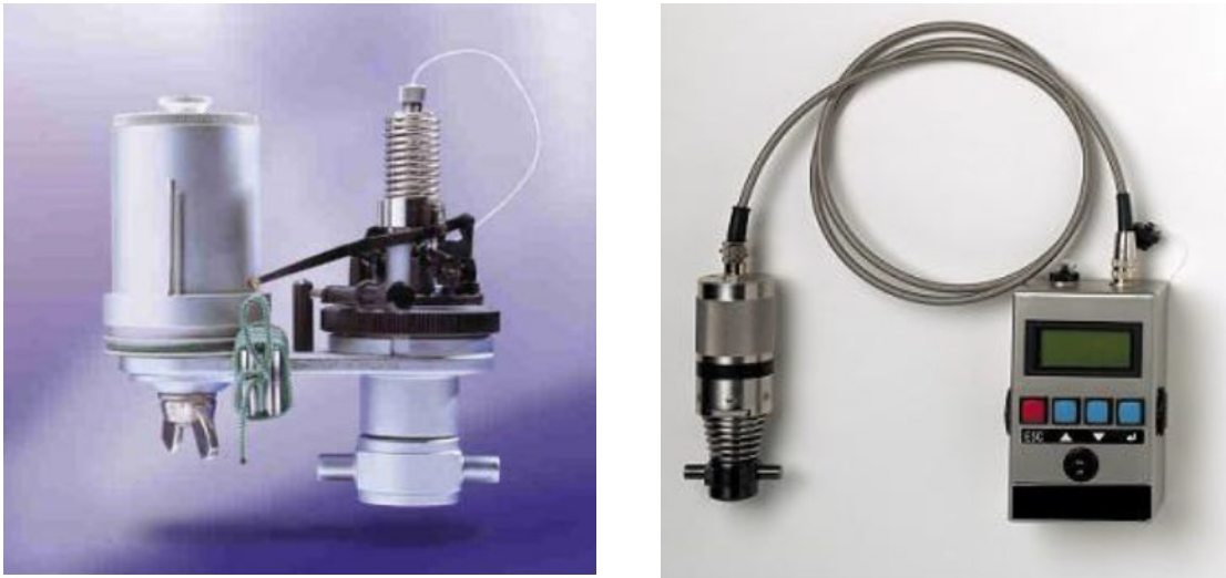
Σχήμα 2.7 Αριστερά: Μηχανικός δυναμοδείκτης, Δεξιά: Ηλεκτρονικός δυναμοδείκτης
