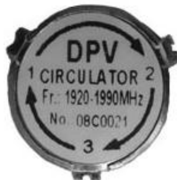
Σχήμα 1.6: Real ferrite circulator
