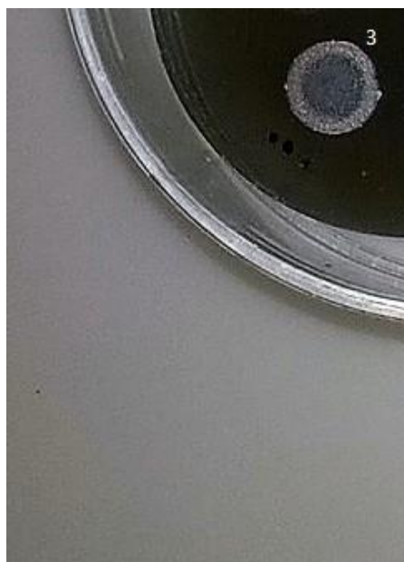
Εικόνα 2.17 Σταγόνα από διάλυμα αντισώματος που στέγνωσε στην ατμόσφαιρα και όπου φαίνεται η συγκέντρωση του αντισώματος στην περιφέρεια.
