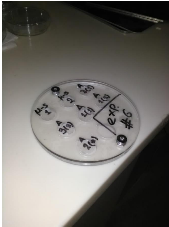
Εικόνα 2.19 Βάση για μεταφορά και αποθήκευση των υποστρωμάτων αποδέκτη.
