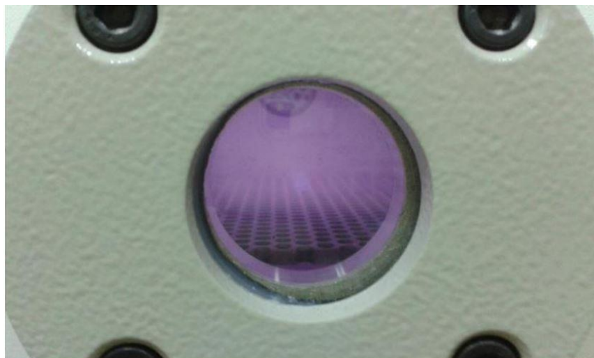
Εικόνα 2.9 Θάλαμος του “Plasma Etcher” κατά τη διαδικασία επεξεργασίας πλάσματος.
