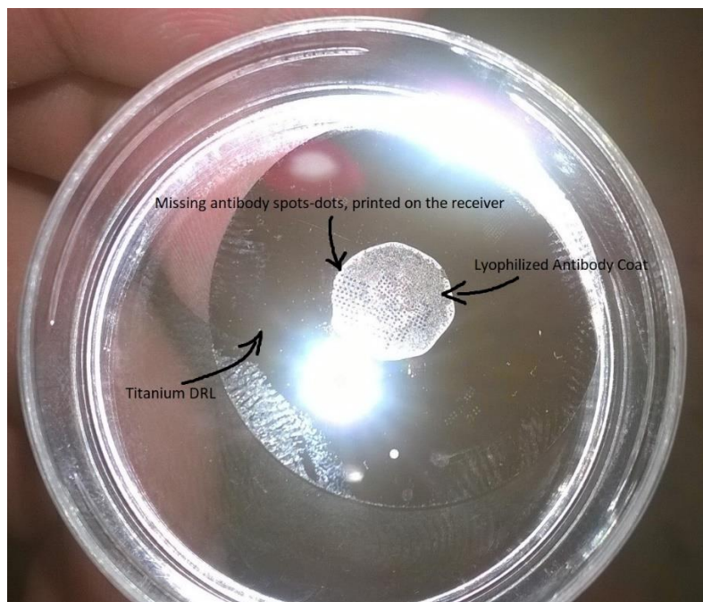
Εικόνα 2.12 Δότης με το στρώμα αντισώματος πάνω του μετά την εκτύπωση .
