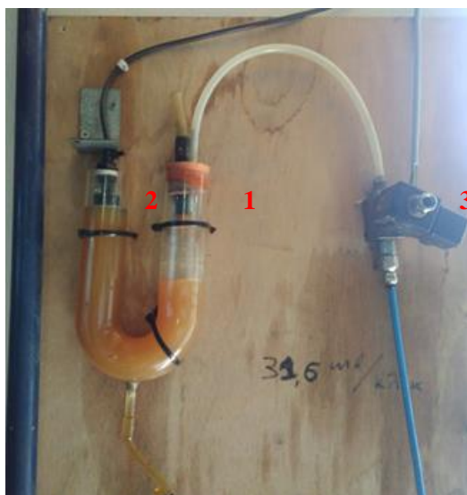
Εικόνα 8: Διάταξη για την μέτρηση του παραγόμενου βιοαερίου (1: Είσοδος βιοαερίου, 2: Πλωτήρας, 3: Τρίοδη ηλεκτροβάννα
