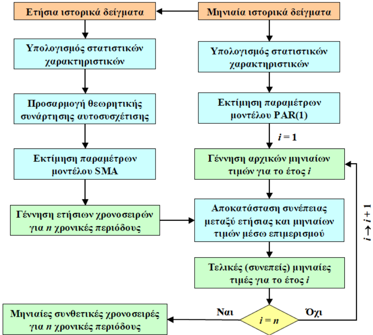
Σχήμα 5.1: Διάγραμμα ροής της διαδικασίας παραγωγής συνθετικών χρονοσειρών σε μηνιαία χρονική κλίμακα, για n συνολικά έτη ([6]).
