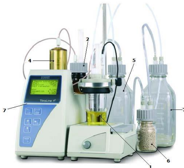
Εικόνα 3.6. Αυτόματος τιτλοδότης TitroLine KF όπου: 1: δοχείο τιτλοδότησης, 2: δοχείο τίτλου, 3: δοχείο διαλύτη, 4: Έμβολο εισαγωγής τίτλου, 5: δοχείο συλλογής αποβλήτων, 6: μοριακά κόσκινα, 7: μονάδα χειρισμού με οθόνη
