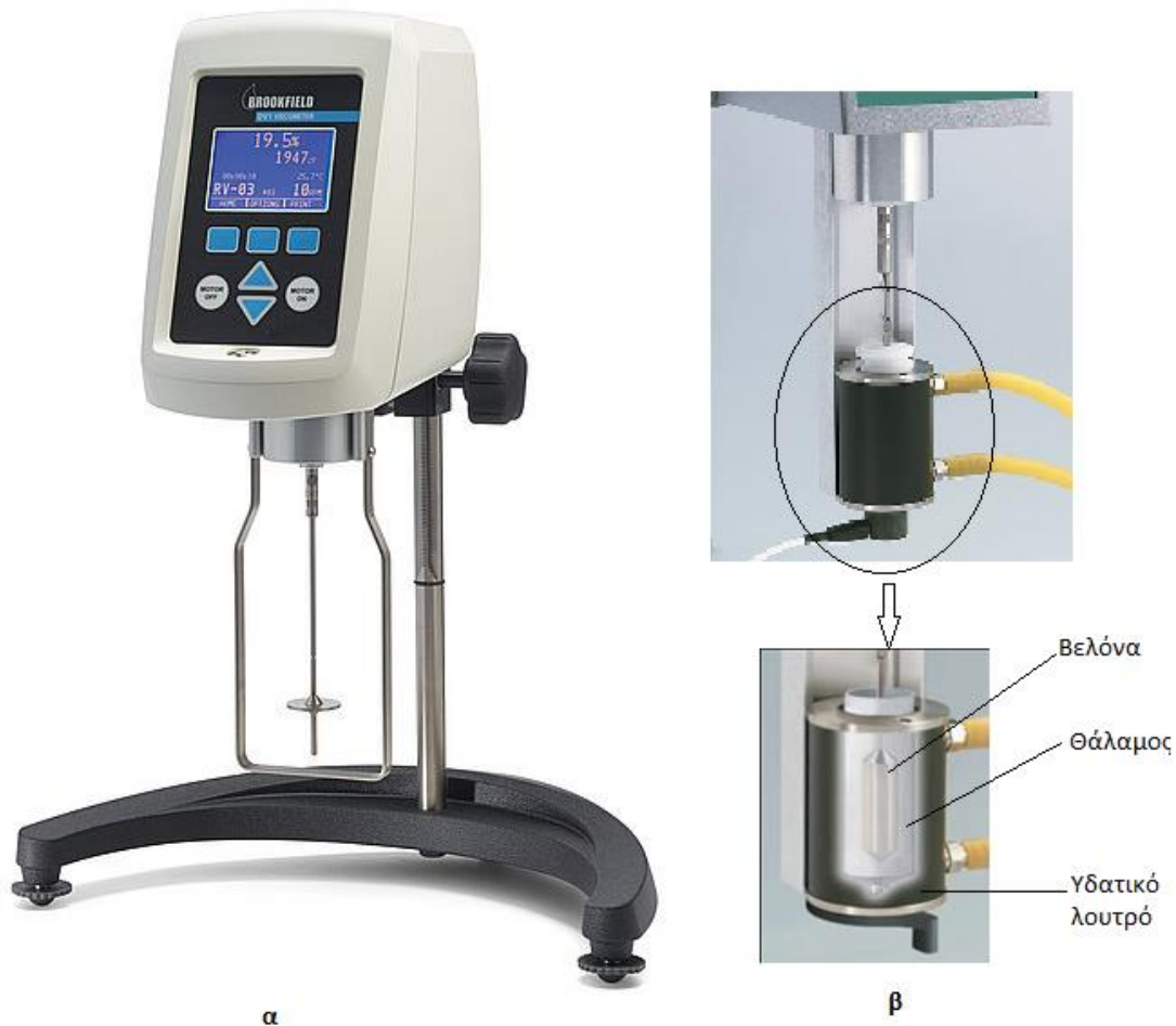
Εικόνα 3.5. Φωτογραφία του ιξωδόμετρου Brookfield DV1 (α) και το σύστημα θαλάμου-βελόνας (chamber-spool) (β) που χρησιμοποιήθηκε για τις πειραματικές μετρήσεις ιξώδους
