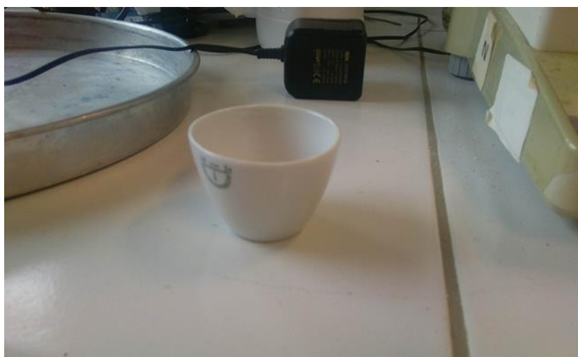
Εικόνα 9. Κάψα πορσελάνης που χρησιμοποιήθηκε κατά την πειραματική διαδικασία
