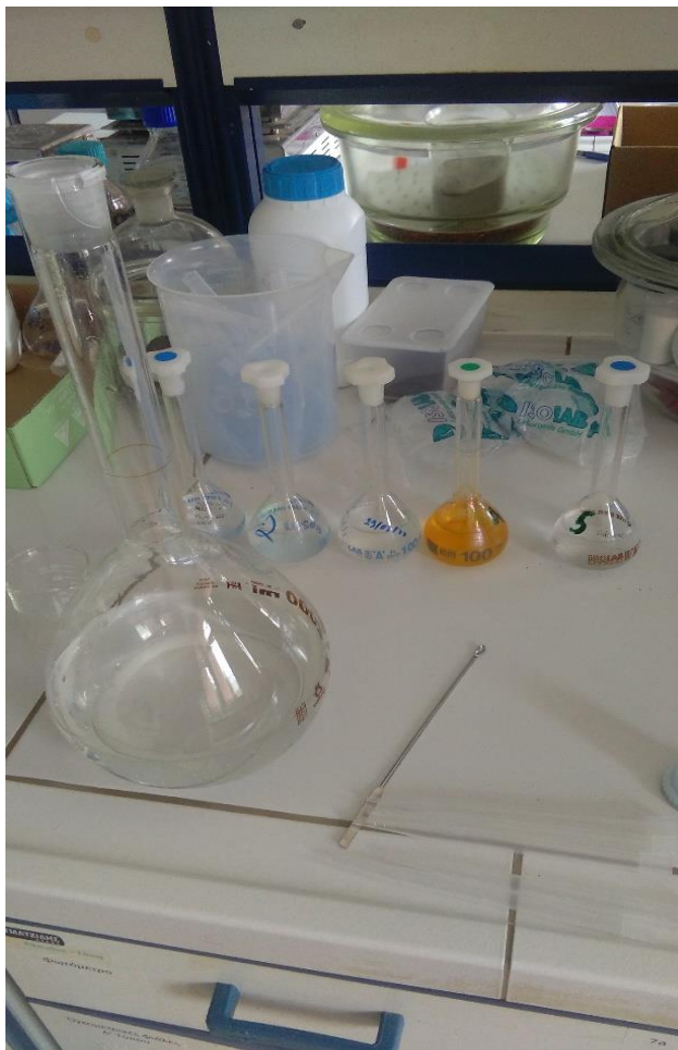
Εικόνα 16. Απαιτούμενες αραιώσεις για την μέτρηση BOD
