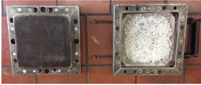
Σχήμα 4.3. Πλήρωση μήτρας θερμής συμπίεσης με ξηραμένους κόκκους PLA
