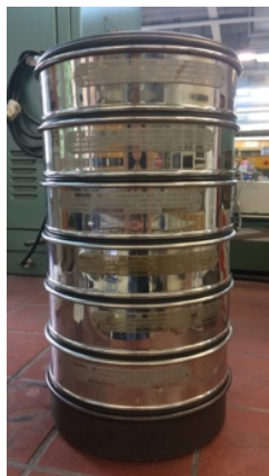
Σχήμα 4.8. Τοποθέτηση κοσκίνων με τις διαμέτρους των οπών ελαττούμενες από επάνω προς τα κάτω
