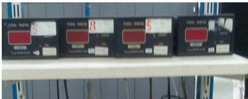
Σχήμα 3.6: Μεταλλάκτες πίεσης Furness control τύπου FC016
