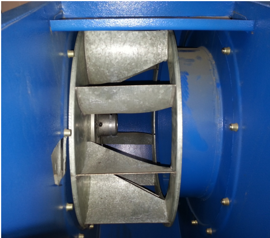
Σχήμα 6.4 : Πτερωτή φυσητήρα-Στεφάνη πτερωτής-πτερόγυα- Τμήμα αγωγού εισόδου
