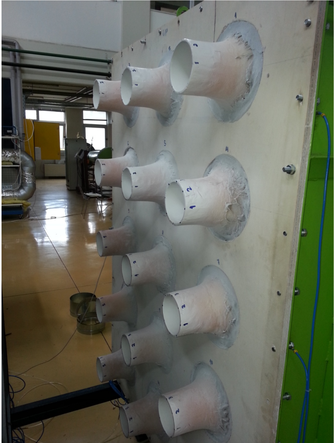
Σχήμα 2.25: Τοποθέτηση ακροφυσίων στην εγκατάσταση
