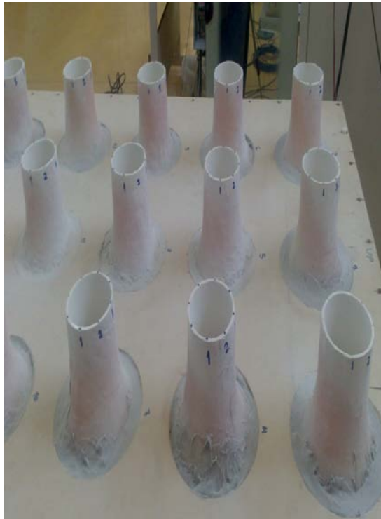
Σχήμα 2.23: Τοποθέτηση ακροφυσίων στη βάση
