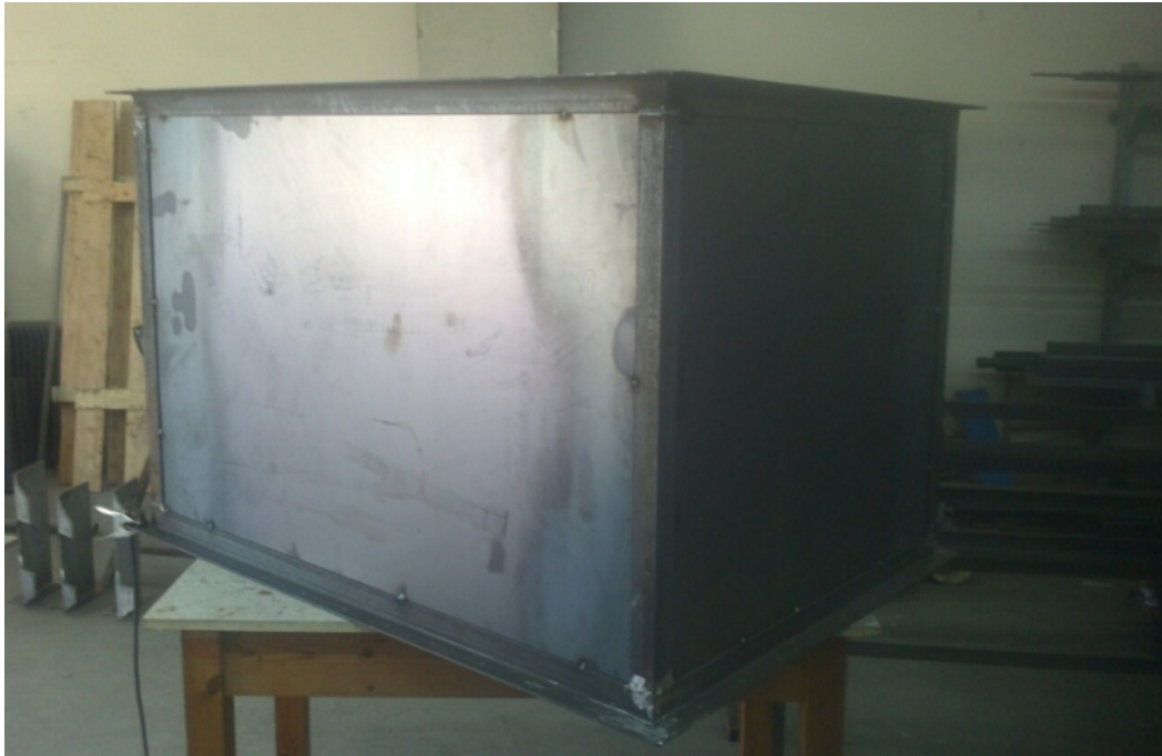
Σχήμα 2.17: Έτοιμο προς βαφή τμήμα του settling chamber
