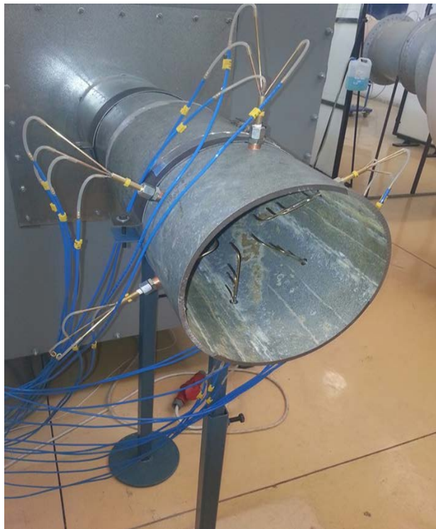
Σχήμα 4.25 : Έξοδος σωλήνων pitot- σύνδεση μέσω σωλήνων με scanivalve
