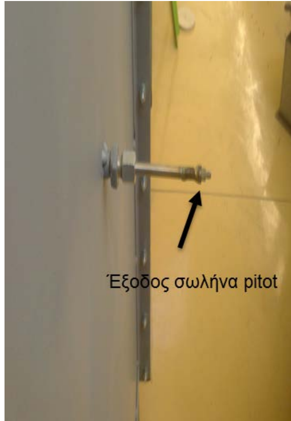
Σχήμα 2.37: Έξοδος σωλήνα pitot
