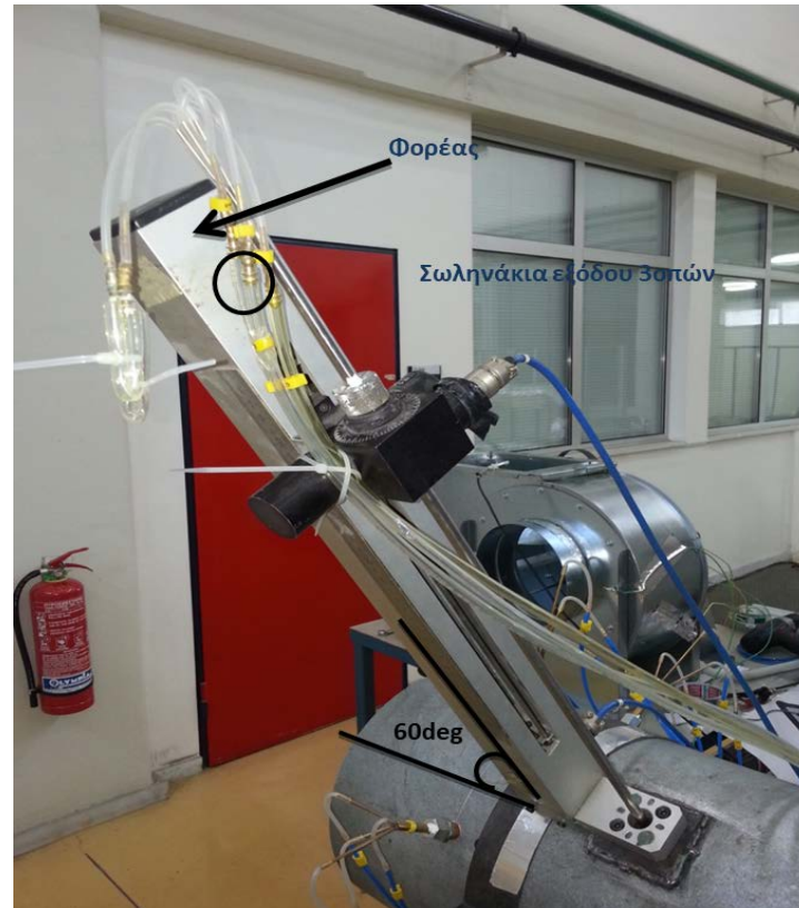
Σχήμα 4.1: Τοποθέτηση 3hole στον αγωγό εξόδου της εγκατάστασης
