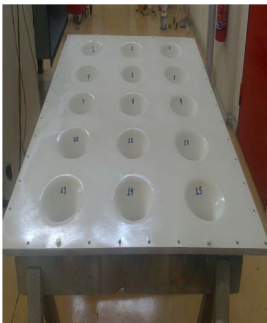
Σχήμα 2.24: Ολοκληρωμένη βάση με τα ακροφύσια
