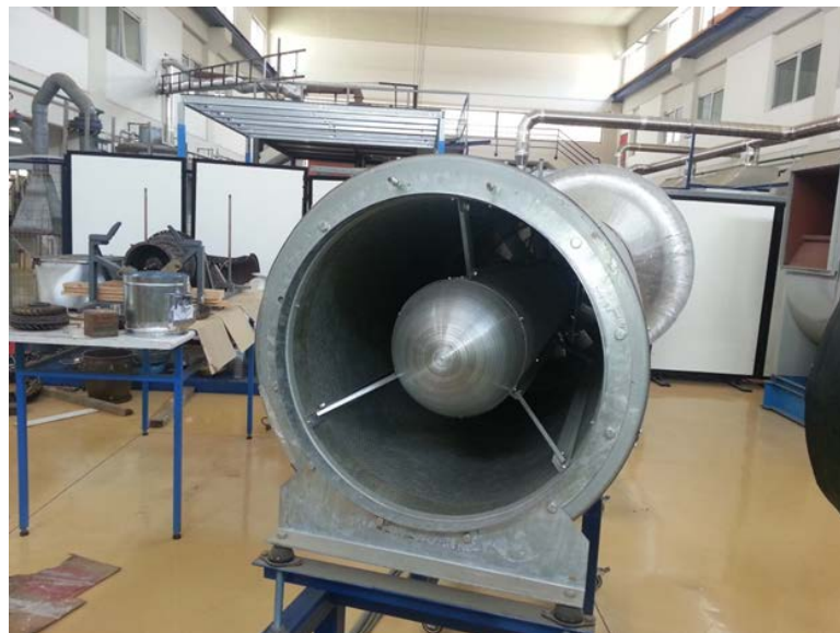
Σχήμα 2.13 : Ο συμπίεστης αντήρροπα στρεφόμενων αξονικών πτερυγώσεων – CRFAN
