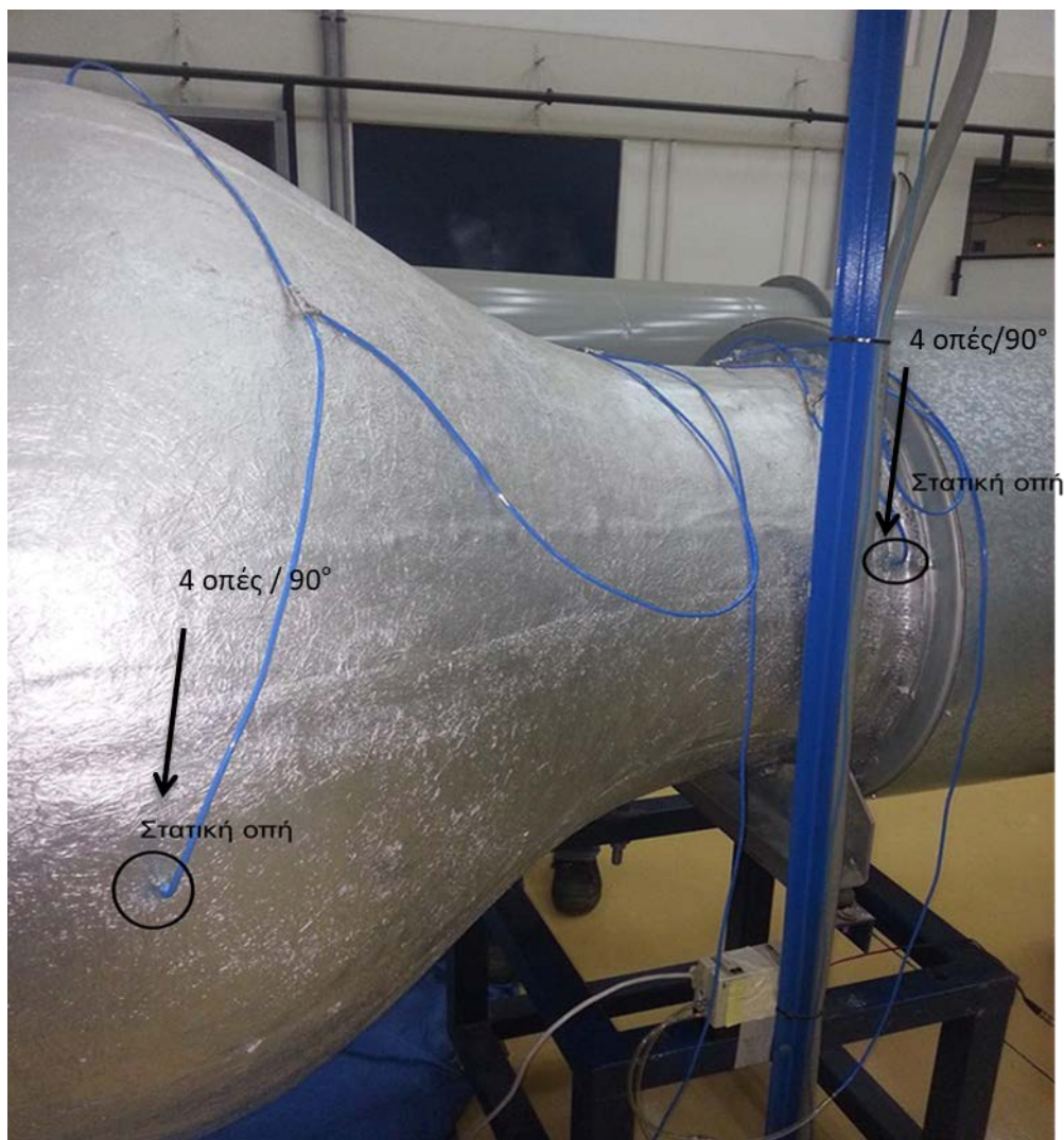
Σχήμα 2.39: Στατικές οπές στην είσοδο της διάταξης
