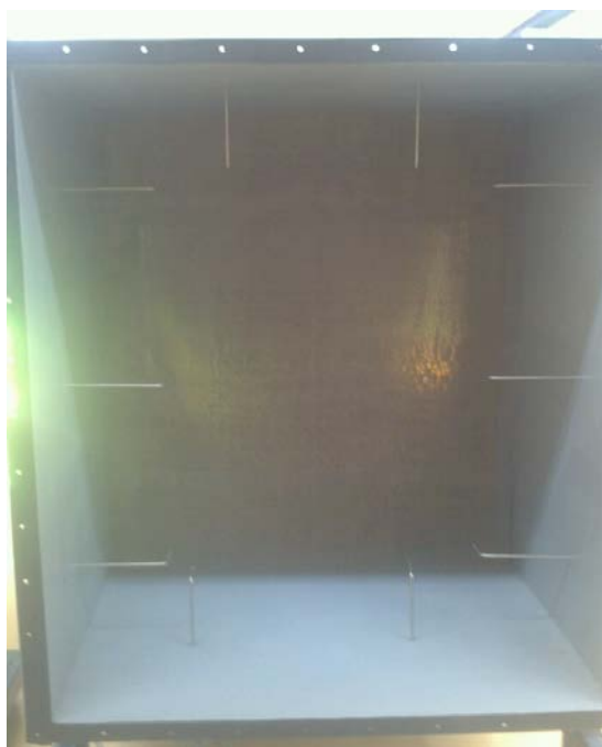
Σχήμα 2.35: Διάταξη σωλήνων pitot
