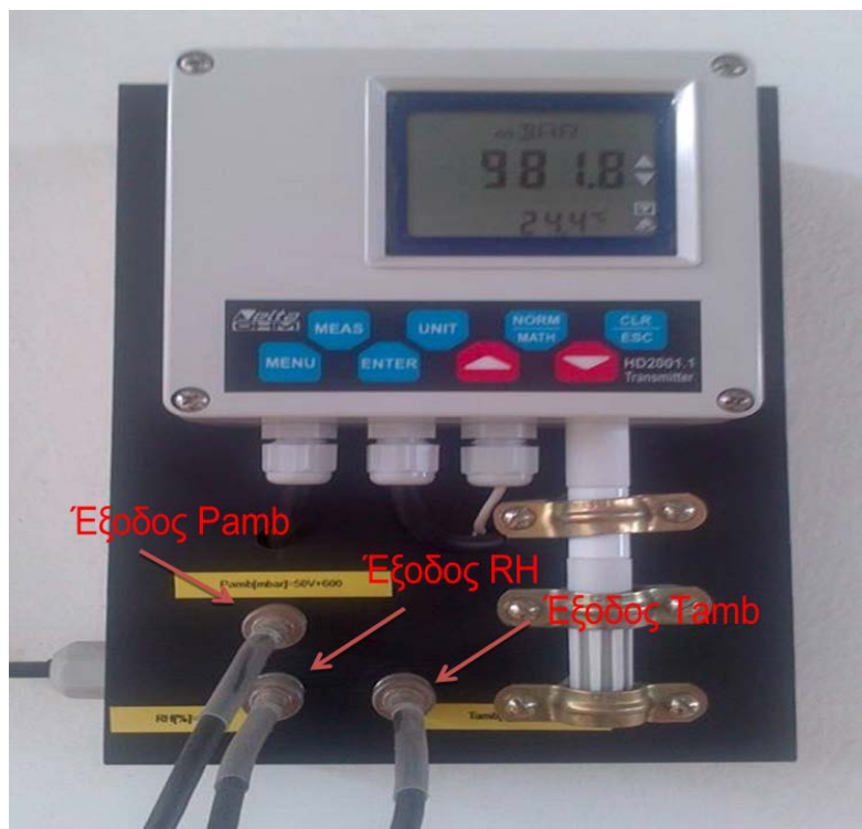
Σχήμα 3.11: Αισθητήρας μέτρησης περιβαλλοντικών συνθηκών
