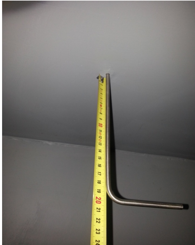
Σχήμα 2.36: Τοποθέτηση σωλήνα pitot
