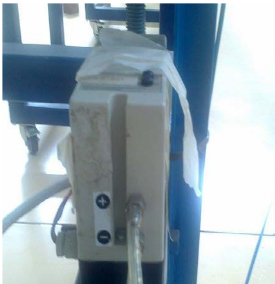
Σχήμα 3.7: Μεταλλάκτης πίεσης Wikatronik
