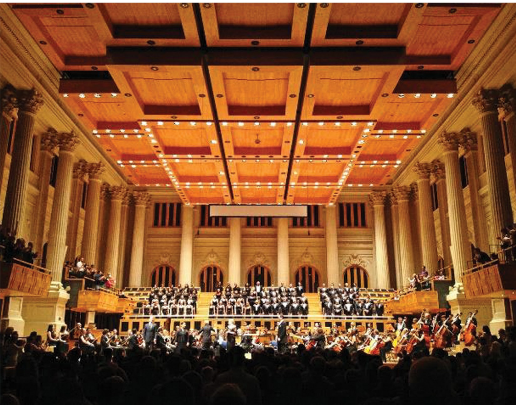
Sala Sao Paolo, Σάο Πάολο, Βραζιλία, 1999 Τα ανεξάρτητα κινητά πάνελ της οροφής επιτρέπουν μεταβολή στον όγκο και το χρόνο αντήχησης του χώρου ακρόασης
