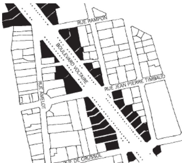
Σχέδιο 8 α,β: Ο ορισμός των οικοδομικών τετραγώνων με τη χάραξη δρόμων. Φαίνεται ο εκ νέου ορισμός των ορίων οικοπέδων ούτως ώστε αυτά να έχουν 'κάθετη' σχέση με τους δρόμους πρόσβασης
