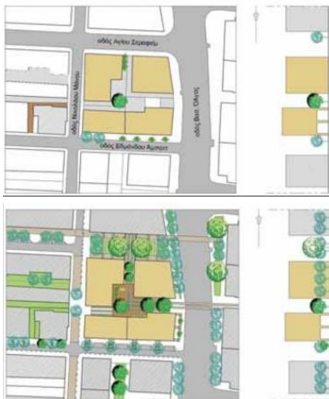
Σχέδιο 83: Πρόταση ενοποίησης των ακάλυπτων σε ενιαίο εσωτερικό υπαίθριο χώρο στη Θεσσαλονίκη, με φυσική διαμόρφωση και εξοπλισμό για την εξυπηρέτηση των υπαίθριων δραστηριοτήτων των κατοίκων Πηγή: Κυόμο, 2007
