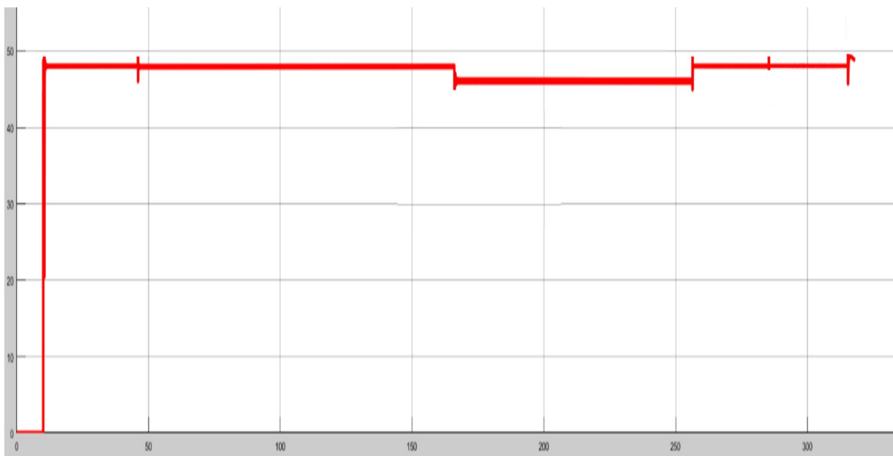
Εικόνα 6.20: Τάση Λειτουργίας Φορτίου (μετάβαση με εκτόξευση από SuperWedge Launcher)
