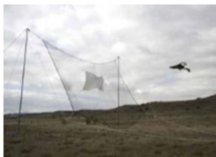
Εικόνα 1.9: Ανάκτηση UAV σταθερού εκπετάσματος με δίχτυ
