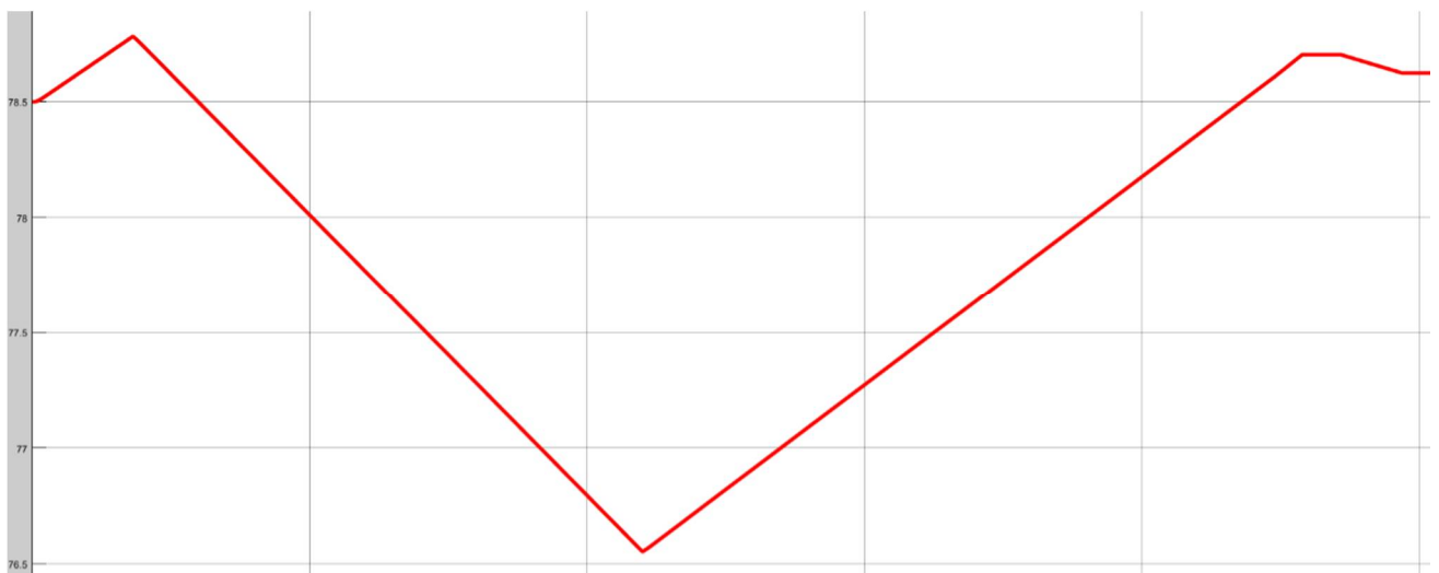
Εικόνα 6.58: SOC Ηλεκτρικού Συσσωρευτή (επιστροφή μέσω συμβατικής προσγείωσης)
