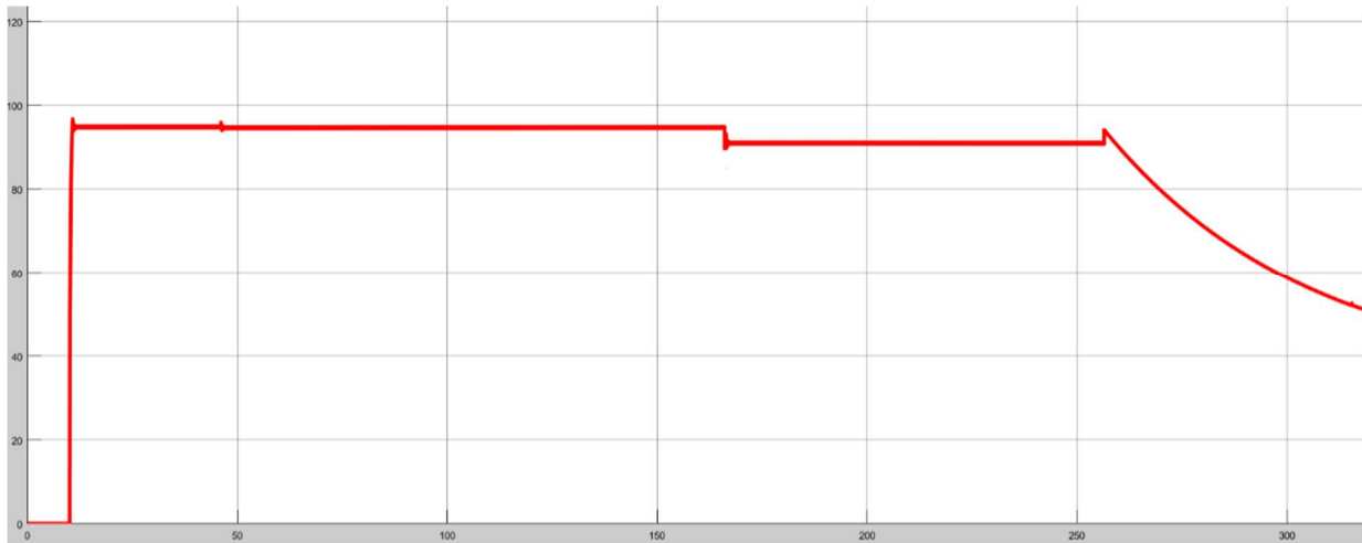
Εικόνα 6.28: Τάση Εξόδου DC Γεννήτριας (μετάβαση με εκτόξευση)
