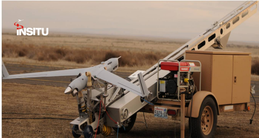
Εικόνα 5.5: Mark 4 Insitu Launcher
