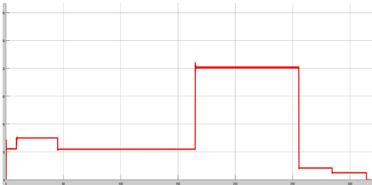
Εικόνα 6.24: Συνολικό Ρεύμα Φορτίου (μετάβαση μέσω συμβατικής απογείωσης)
