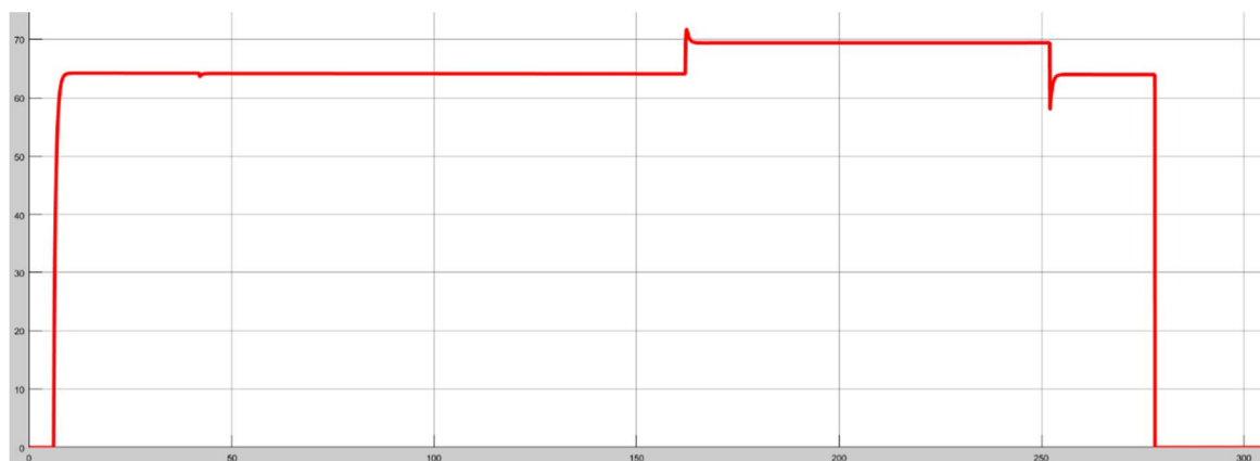
Εικόνα 6.48: Ρεύμα Εξόδου Κυψέλης Καυσίμου (μετάβαση με εκτόξευση)
