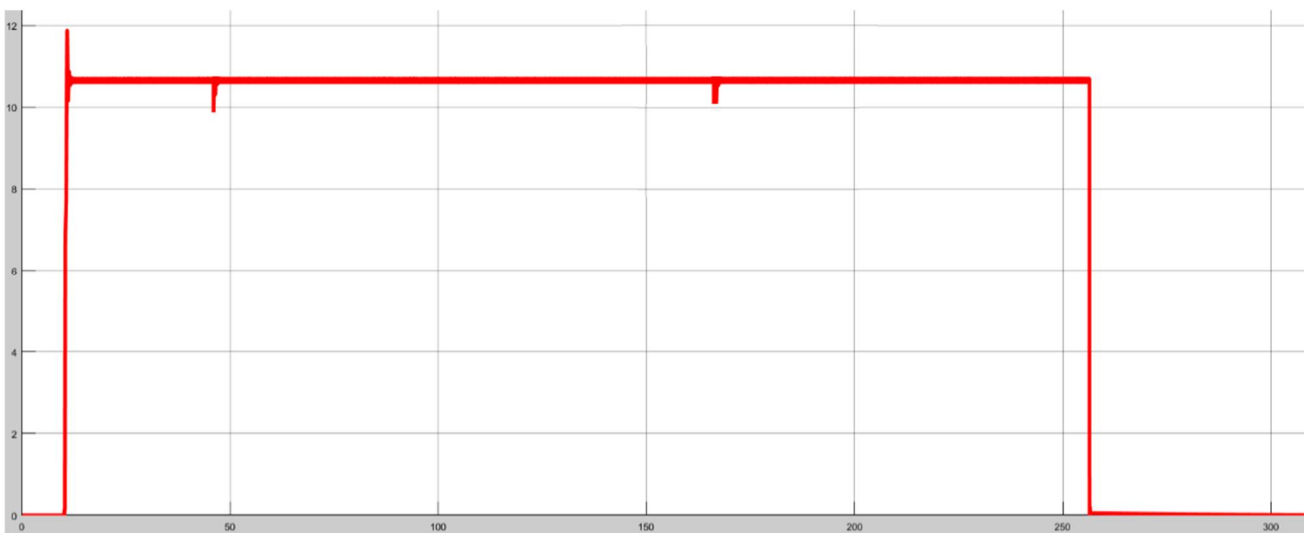
Εικόνα 6.27: Ρεύμα Εξόδου DC Γεννήτριας (μετάβαση με εκτόξευση)
