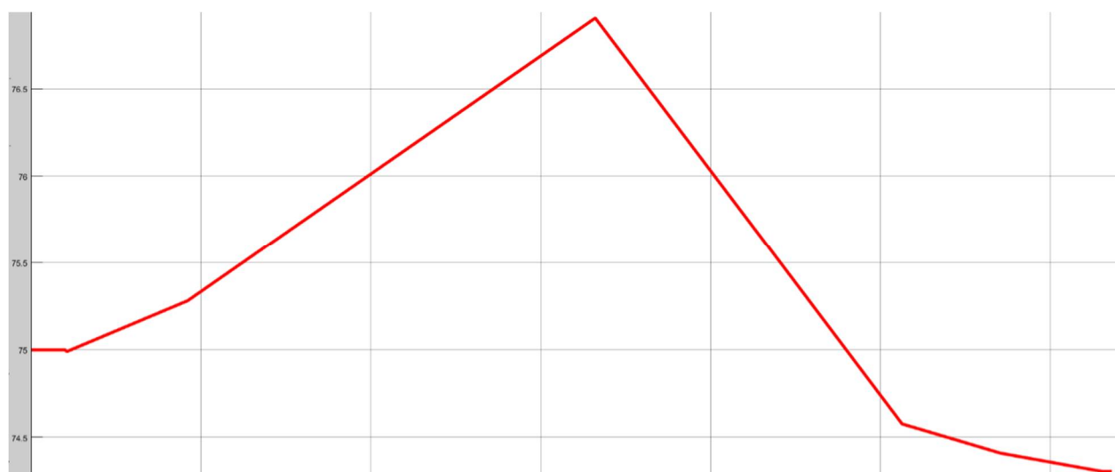
Εικόνα 6.33: SOC Ηλεκτρικού Συσσωρευτή (μετάβαση με εκτόξευση)
