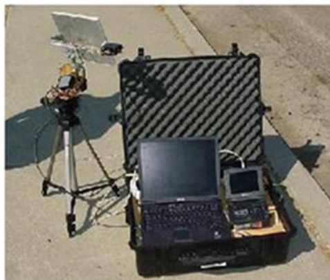
Εικόνα 5.4: Φορητός επίγειος σταθμός ελέγχου του ScanEagle
