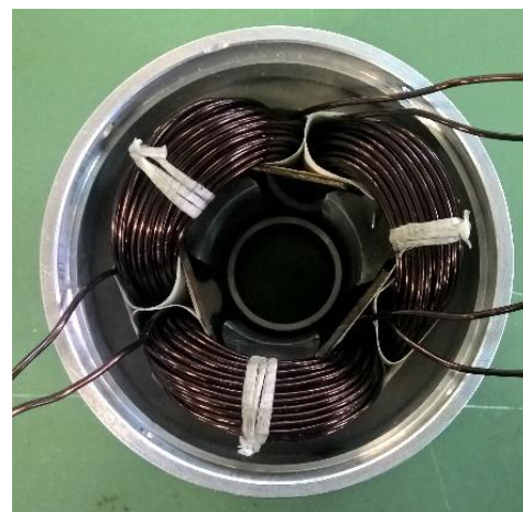
Σχήμα 7.2 Το εσωτερικό της ηλεκτρικής μηχανής (Στάτης) κατασκευασμένη στο εργαστήριο. [10]
