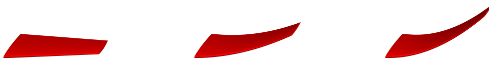
Σχήμα 5.5: Κάμψη της πτέρυγα ONERA M6. Το σχήμα της αρχικής πτέρυγας (αριστερά) και της παραμορφωμένης πτέρυγας, σε δύο διαφορετικές θέσεις (κέντρο, δεξιά).
