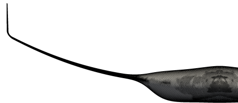
(γ') Το παραμορφωμένο πλέγμα γύρω από το (δ') Η παραμορφωμένη γεωμετρία του αεροσκάφους, για \alpha = 0.50 .
