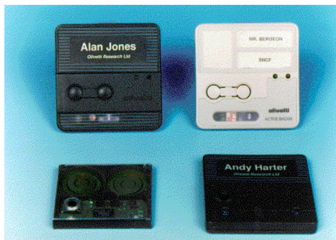
Εικόνα 3.1 Ενεργός ραδιο- φάρος σε μορφή κονκάρδας (πηγή cl.cam.ac.uk) Image 3.1 Active badge (source cl.cam.ac.uk)
