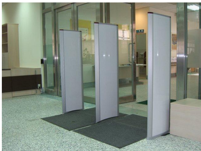
Εικόνα 3.11 Πύλες RFID σε πολυκατάστημα (πηγή rfid-library.com) Image 3.11 RFID gates in department store (source rfid-library.com)
