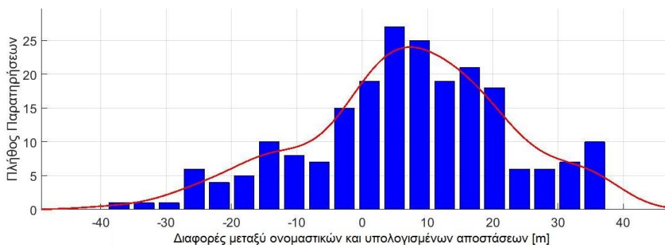
Σχήμα 7.3 Ιστόγραμμα διαφορών ονομαστικών αποστάσεων από υπολογισμένες με μοντέλο εξασθένησης One-Slope
