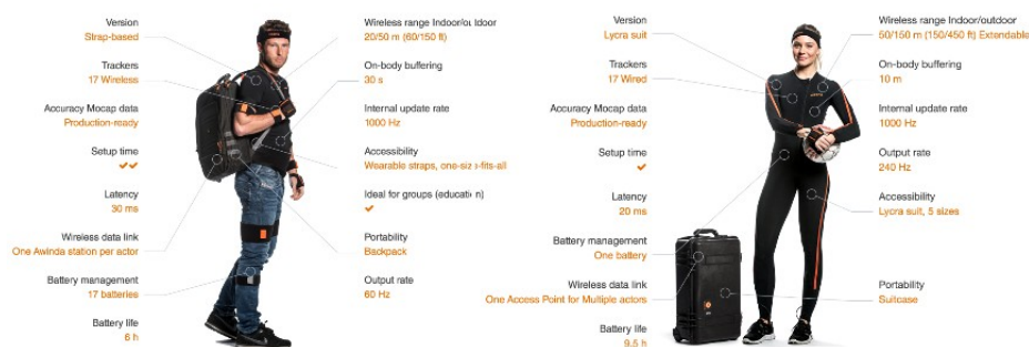
Εικόνα 20: Το εμπορικό αδρανειακό σύστημα MVN της εταιρίας Xsens σε δύο εκδοχές. Στην πρώτη οι αισθητήρες είναι ασύρματοι και δένονται με ιμάντες στο σώμα, ενώ στη δεύτερη οι αισθητήρες συνδέονται με καλώδια και είναι ενσωματωμένοι σε στολή Lycra. Και στις δύο εκδοχές υπάρχει μονάδα ασύρματης ζεύξης δεδομένων σε σακίδιο και βαλίτσα αντίστοιχα. (Πηγή: xsens.com)
