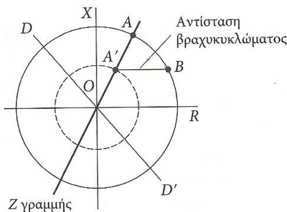
Σχήμα 1.19: Ελάττωση όπως επέκτασης του ηλεκτρονόμου σύνθετης αντίστασης λόγω όπως αντίστασης βραχυκυκλώματος
