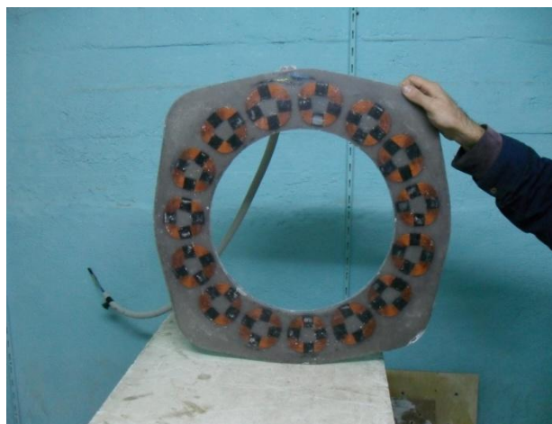
Σχήμα 6.8: Ο στάτης είναι έτοιμος για τοποθέτηση.
