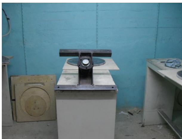
Σχήμα 6.9: Η κατασκευή στήριξης της γεννήτριας. Πρόκειται για μια “Γ” κατασκευή από χάλυβα.
